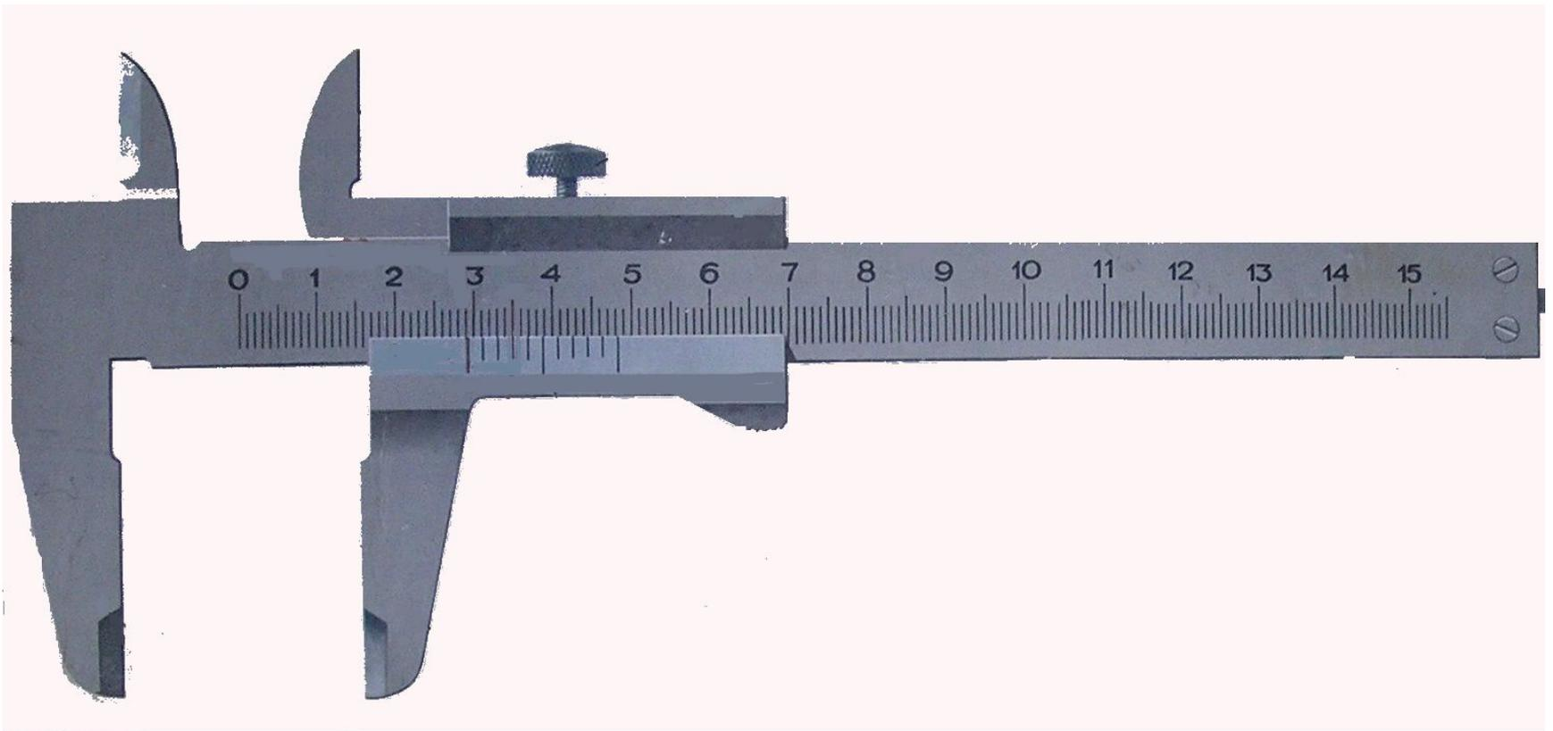
**НОНИУС** - вспомогательная шкала, при помощи которой отсчитывают доли делений основной шкалы измерительного прибора.
