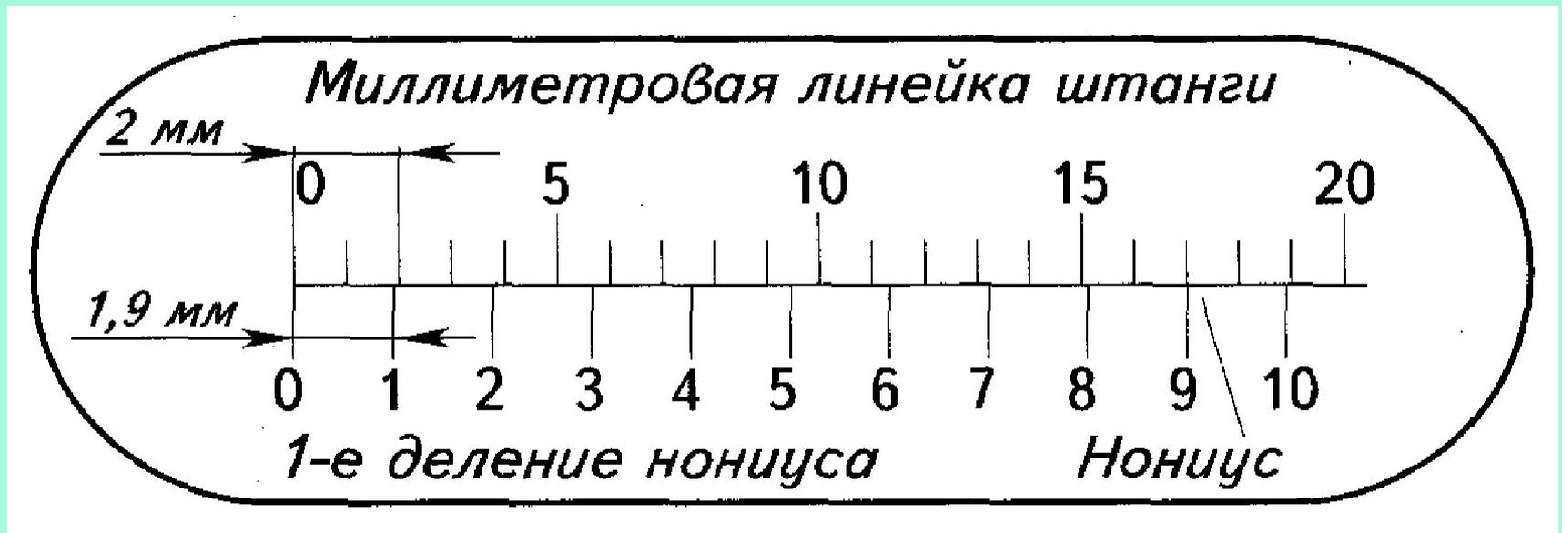
$$2\text{мм} - 1,9\text{мм} = 0,1\text{мм}$$
