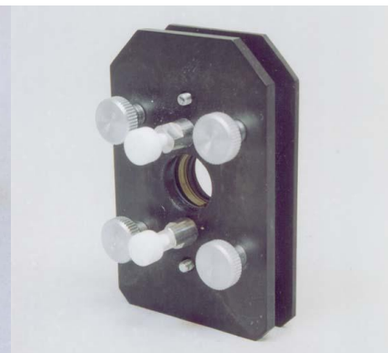
Кювета жидкостная разборная
