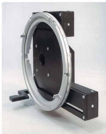
Приставка для измерения пропускания пластин
