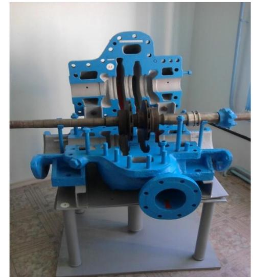
Корпус ЦН представляет собой разъемную металлическую отливку, имеющую форму улитки, с 2 фланцами – всасывающим и напорным. Внутри, на валу, располагается рабочее колесо открытого или закрытого типа. Последнее состоит из 2 дисков, между которыми расположены лопасти, изогнутые в направлении, противоположном вращению. В переднем диске имеется отверстие, расположенное напротив всасывающего патрубка.
