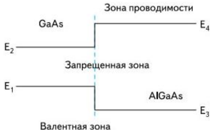
Рис. 7 - Формирование гетероперехода между полупроводниками с различной шириной запрещенной зоны
