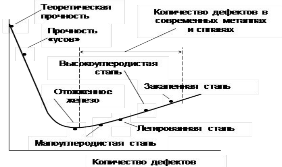
Рис. 1.4. Влияние количества дефектов на прочность сплава (стали).
