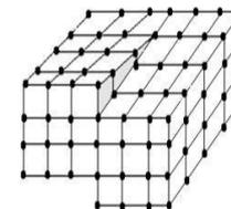
**Винтовая дислокация** получается при частичном сдвиге кристаллической решетки. При этом образуется ступенька, проходящая по части кристалла.
