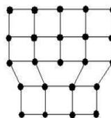
**Краевую дислокацию** образует лишняя атомная полуплоскость (экстраплоскость) образованная в части кристалла.
