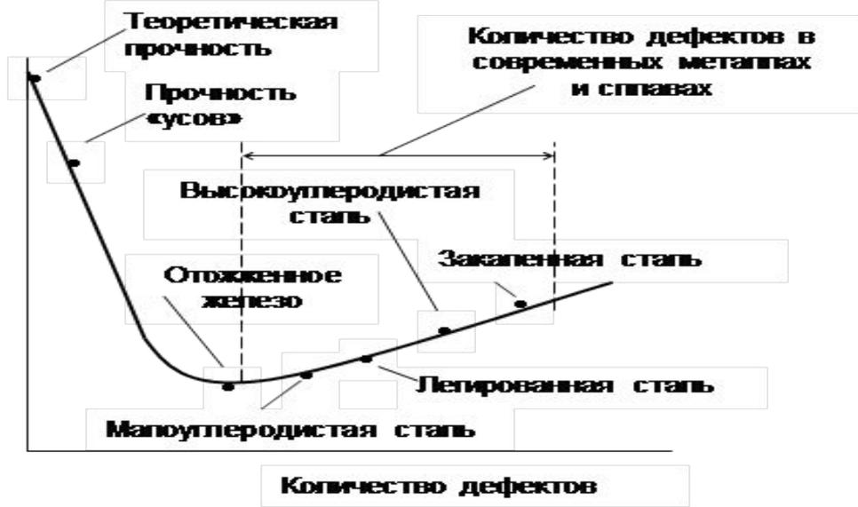
Рис. 1.4. Влияние количества дефектов на прочность сплава (стали).
