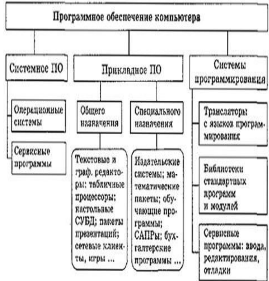
Рис. 7.1. Структура программного обеспечения компьютера
