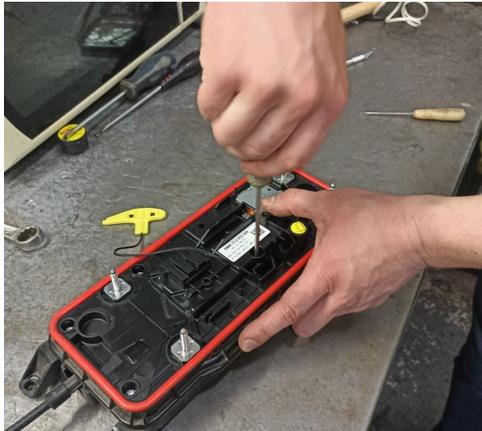
**10. Установить селектор в обратной последовательности. Удалить зарегистрированные события всех блоков. Провести тестовую поездку во всех режимах. Не менее 10 раз остановка, постановка в паркинг.**
