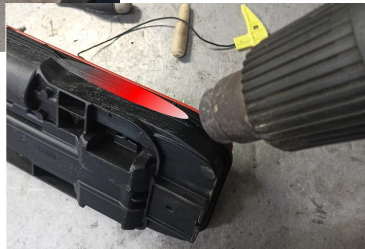
4. Разъединить корпус с помощью плоской отвертки 5-7 мм
