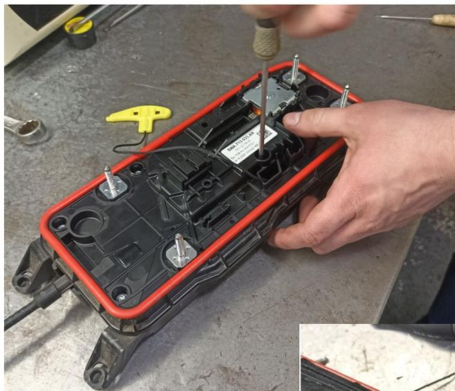
3. Разогреть феном 90-120C стыковочную поверхность половин корпуса
