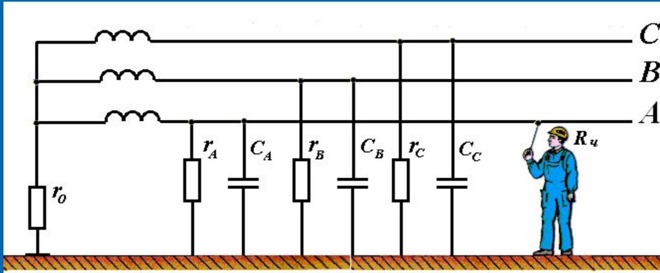
однофазное прикосновение:  $I_h = U_{\phi} / R_h + R_0$
