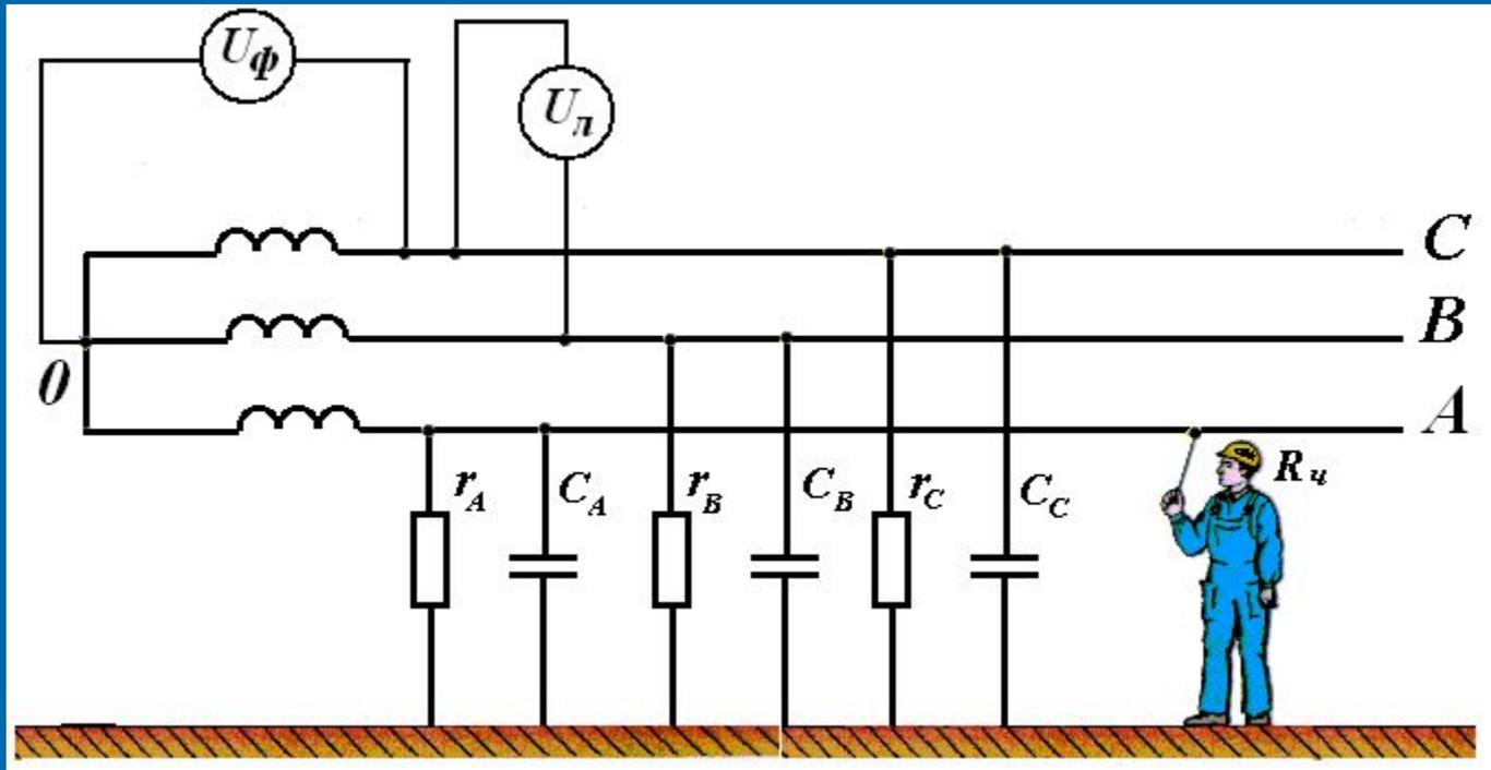
однофазное прикосновение:  $I_h = U_\phi / (R_h + r/3)$
