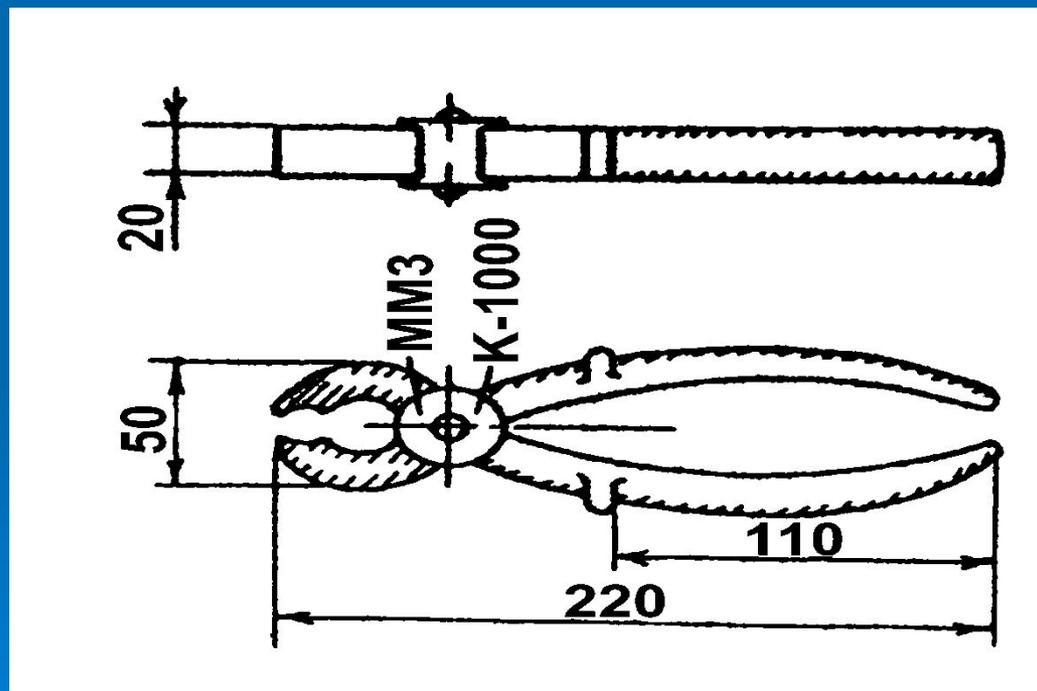
**Установка (снятие) трубчатого патрона плавкого предохранителя под напряжением выше 1000 В с помощью изолирующих клещей**
