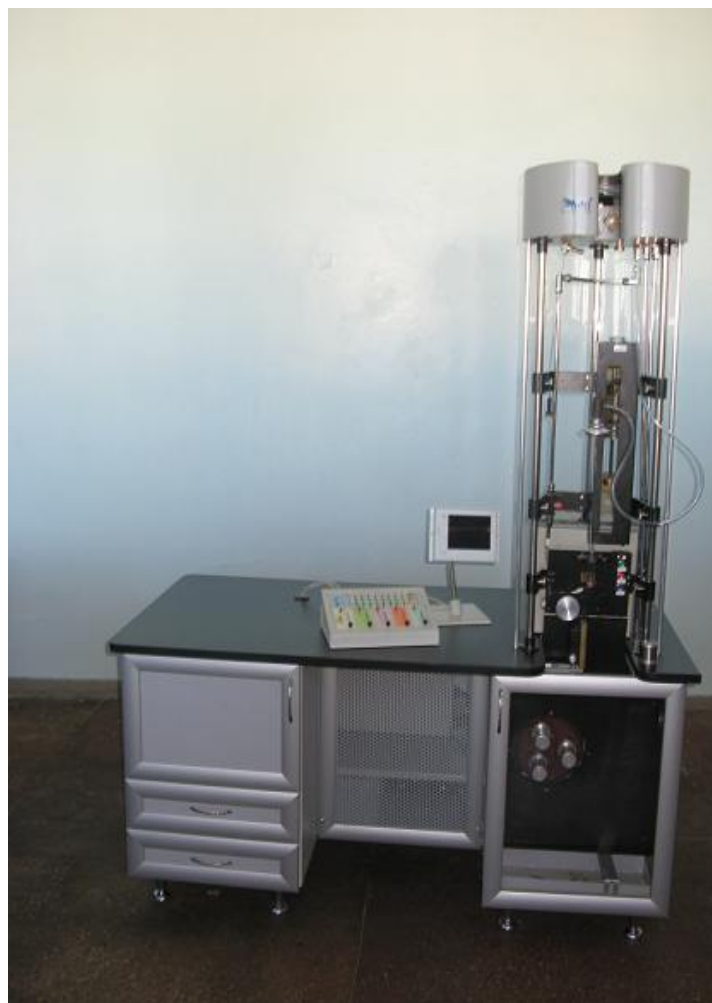
Установка для литья микропровода ITMF-3 Разработка МFTI
