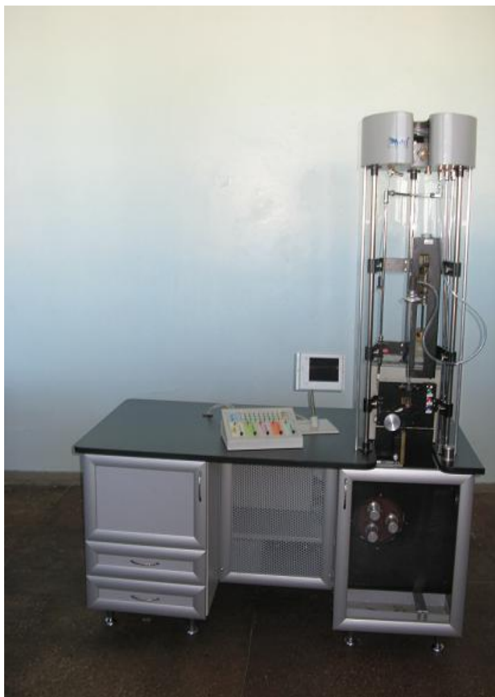
Установка для литья микропровода ITMF-3 Разработка МФТИ
