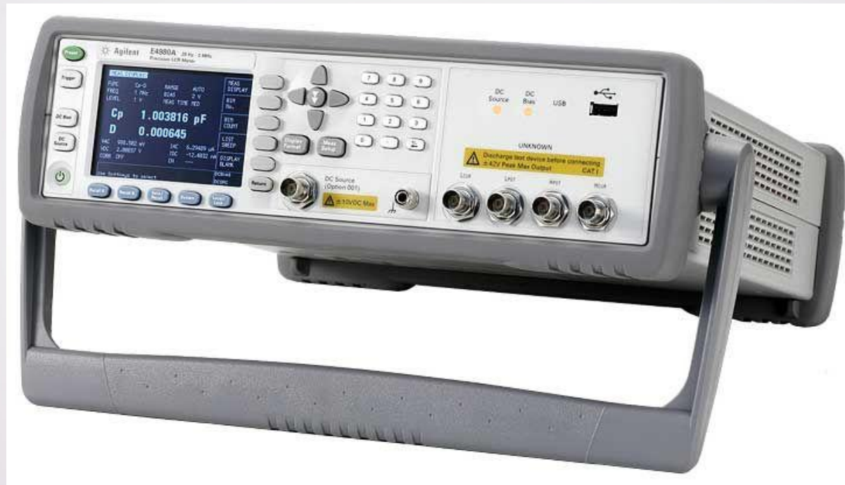
Рисунок 3 – Общий вид установки Agilent E4980A Precision LCR Meter
