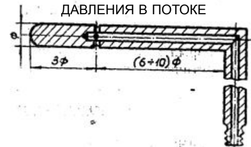
Зонд для ИЗМЕРЕНИЯ СТАТИЧЕСКОГО ДАВЛЕНИЯ В ПОТОКЕ
