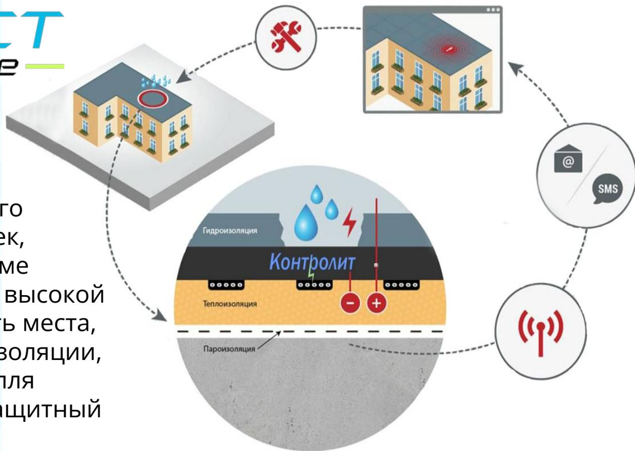
Система непрерывного мониторинга протечек, позволяющая в режиме реального времени с высокой точностью обозначать места, повреждения гидроизоляции, как только первая капля просочилась через защитный слой.
