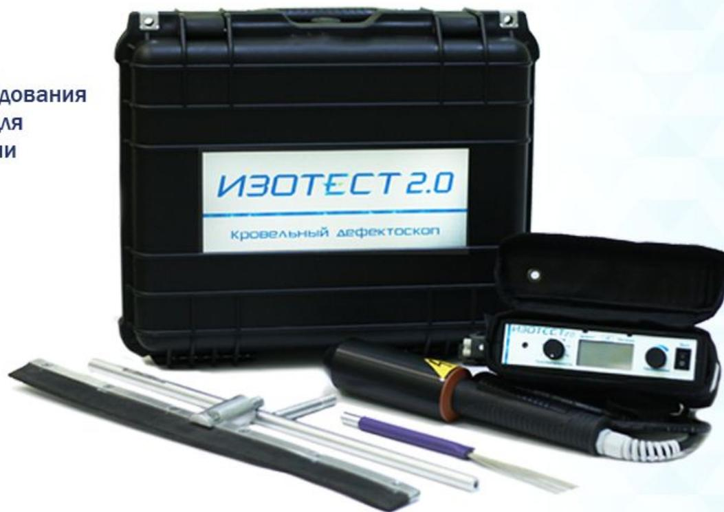
**Применение:** сверхточная инструментальная диагностика герметичности гидроизоляции плоских кровель, фундаментов, бассейнов, а также разнообразных технических резервуаров.
