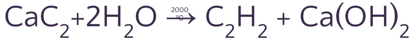
Карбид кальция получают при нагревании ( $2000\text{ }^{\circ}\text{C}$ ) угля с негашёной известью в электропечах. Этот способ называется карбидным
