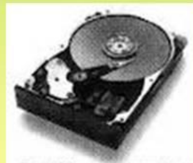
Рис. 5.5. Жесткий магнитный диск
