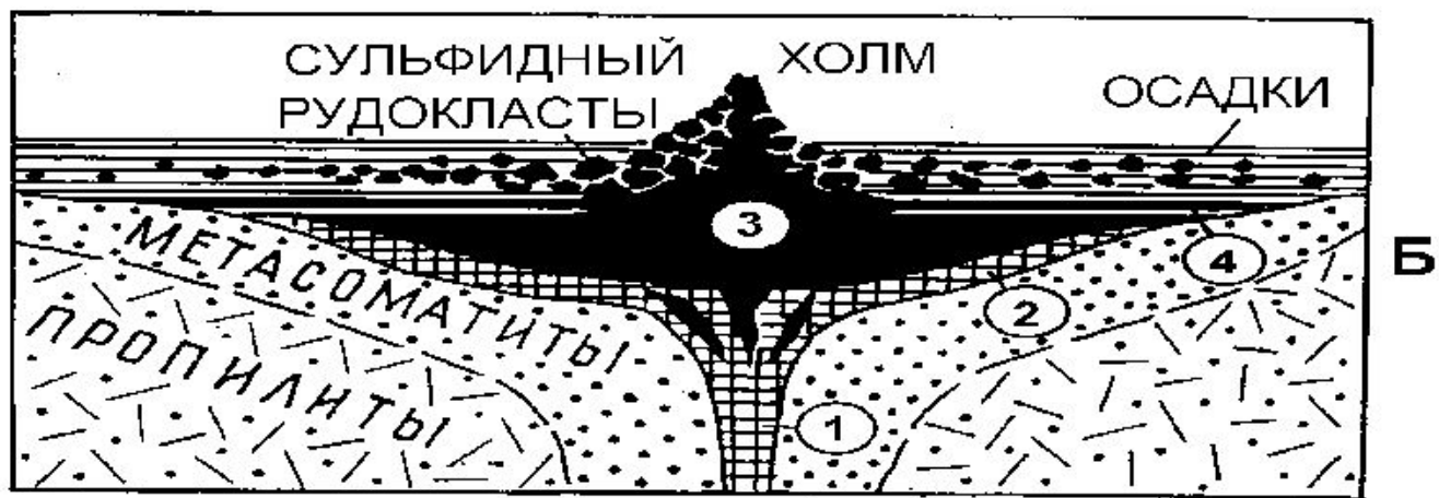
Рис. 9. Принципиальная геологическая модель рудогенерирующей вулканической постройки (А) и медно-цинковоколчеданной залежи (Б) базальтового типа [40].
