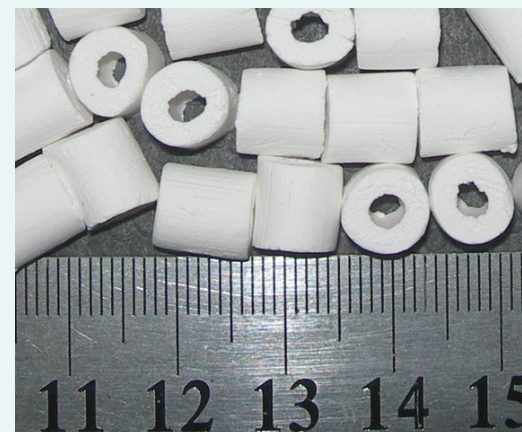
катализатор марки АОК, (\gamma + \chi) - \text{Al}_2\text{O}_3 ТУ 6-68-146-02; АО «Катализатор», г, Новосибирск, Россия
