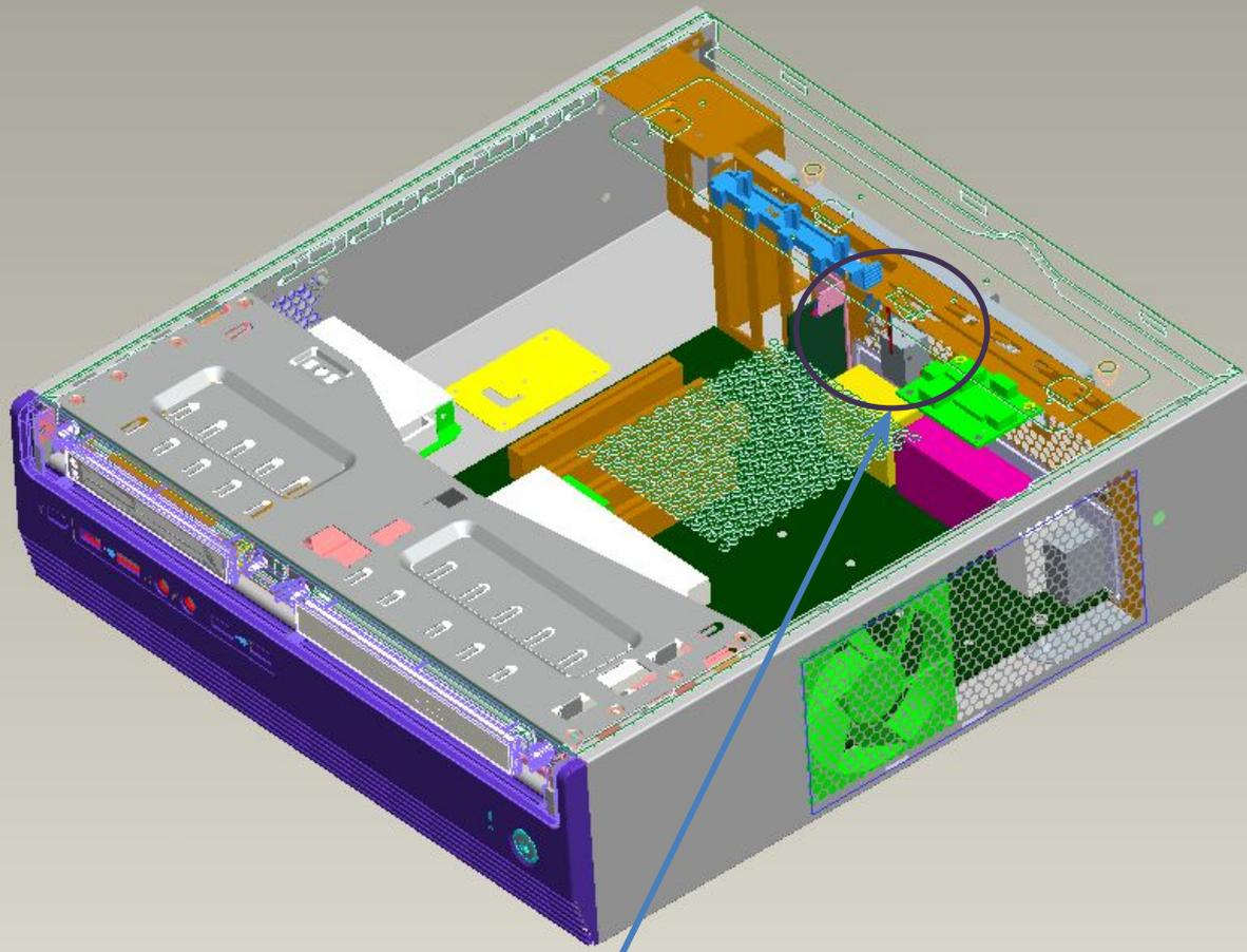
После установки верхней панели штифт замка и «арочный мост» создадут надежный затвор, препятствующий открытию верхней крышки.
