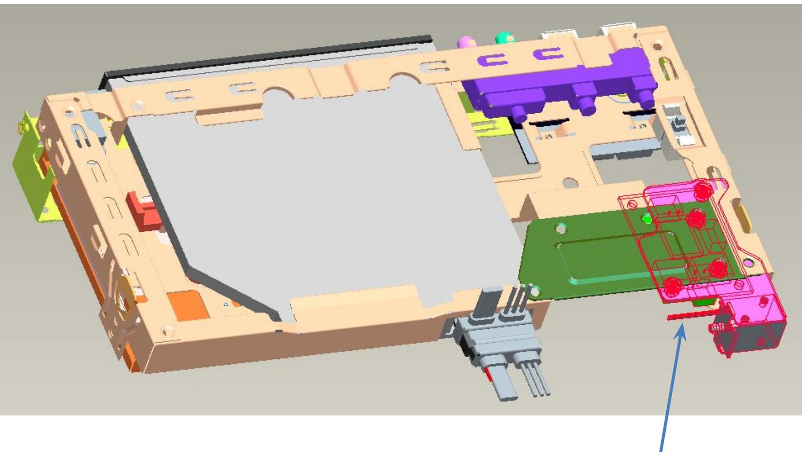
Закрепление всего комплекта деталей электромагнитного замка с помощью двух болтов КМЗ\*4, как показано на рисунке.
