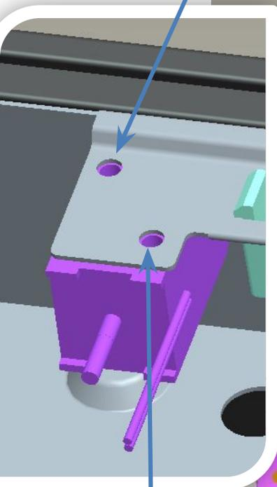
Закрепите электромагнитный замок посредством двух болтов М2\*4
