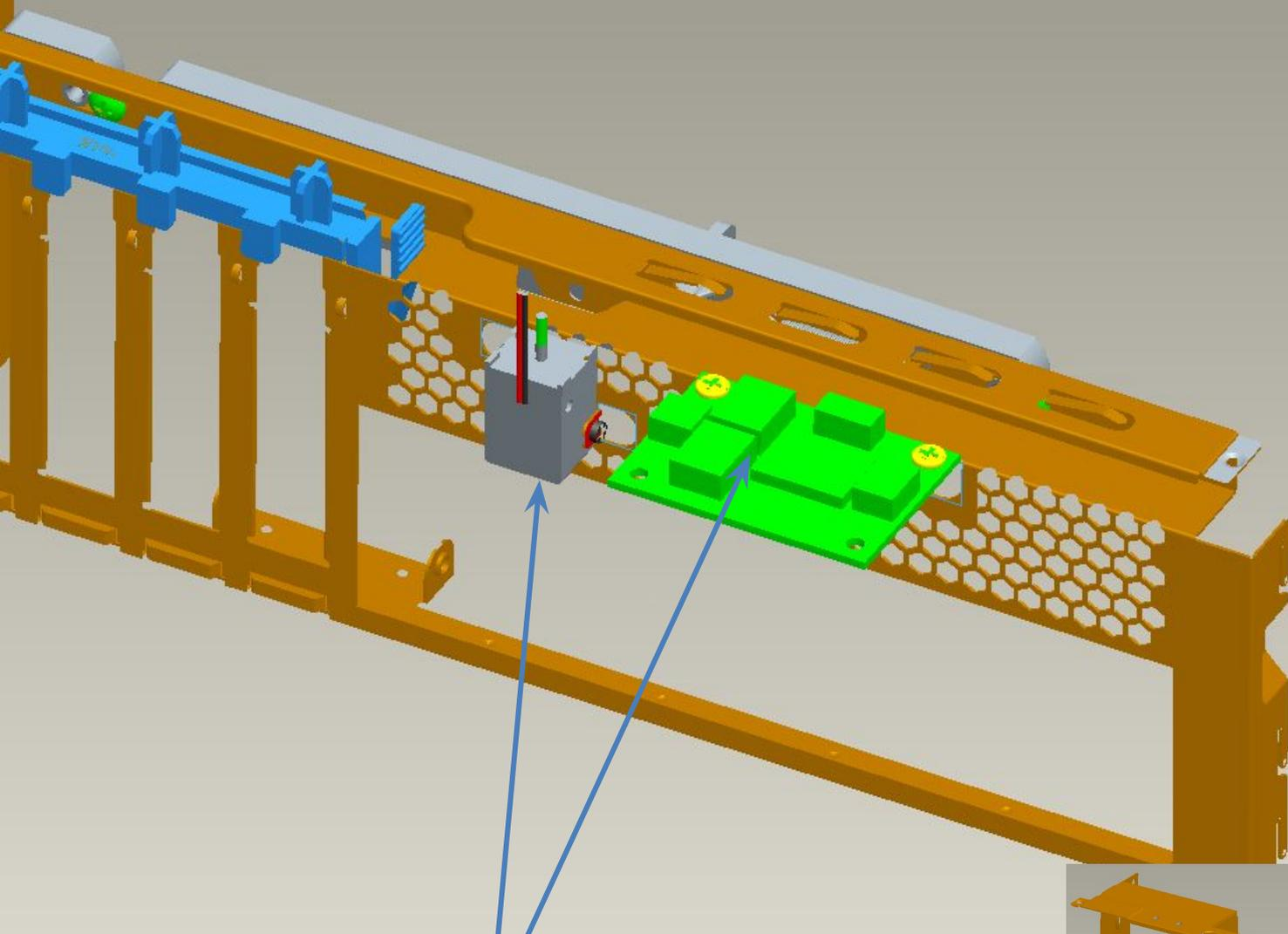
Закрепление электромагнитного замка и РСВА на задней панели корпуса Н100, для этого необходимы ЕСН для заднего окна корпуса Н 100.
