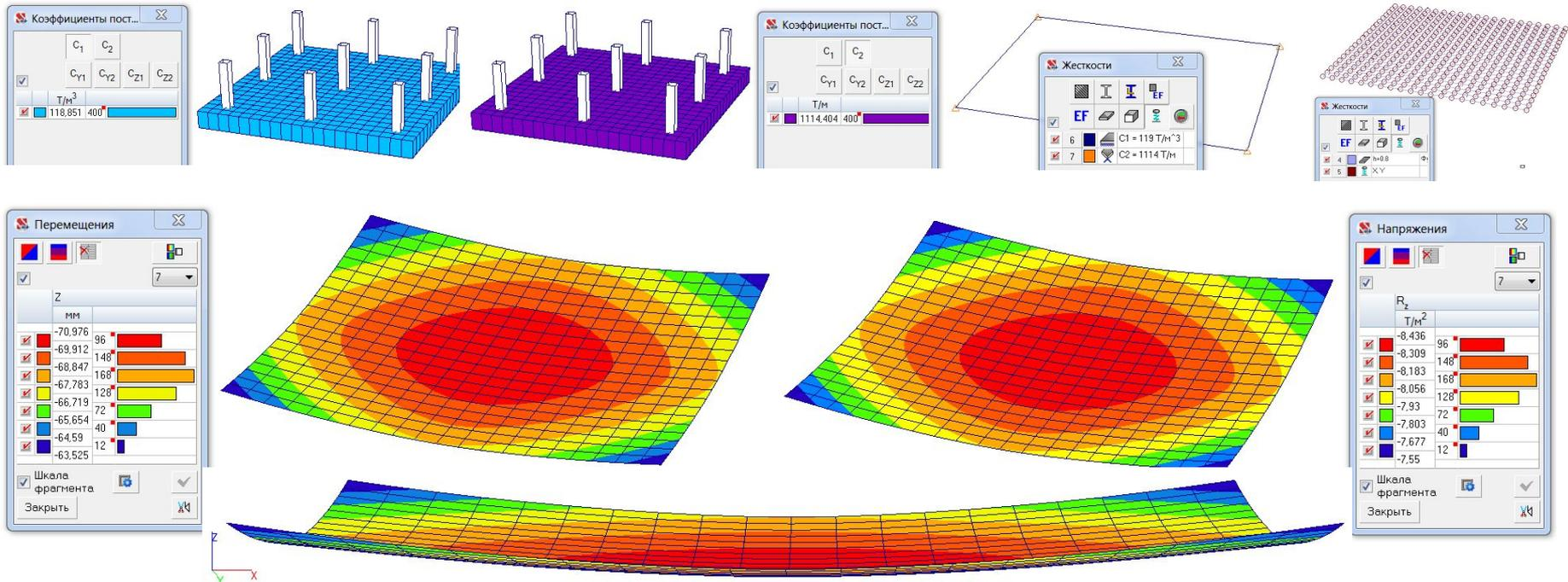
**Главный недостаток — приближенность калибровки модели в разных методиках расчета  $C_1$  и  $C_2$ , а также применимость только к однородному в плане и по толщине грунтовому массиву.**
