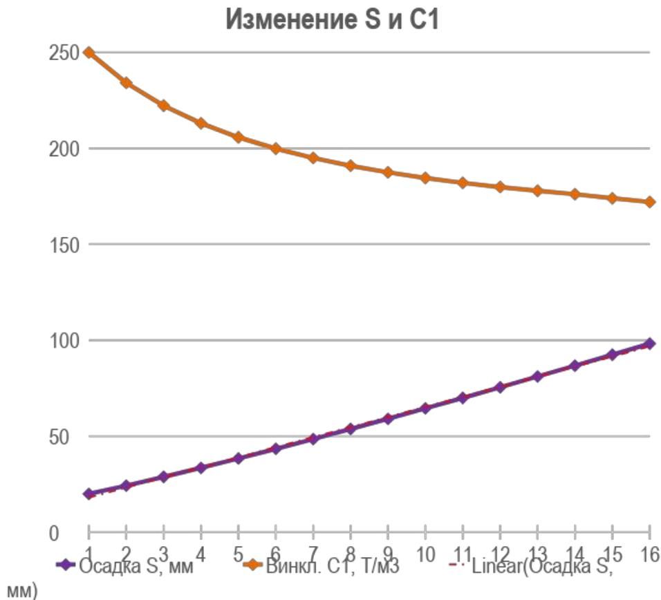
Расчет без пересчета НДС на каждой стадии монтажа. **Снижение осадки на 16%.**
