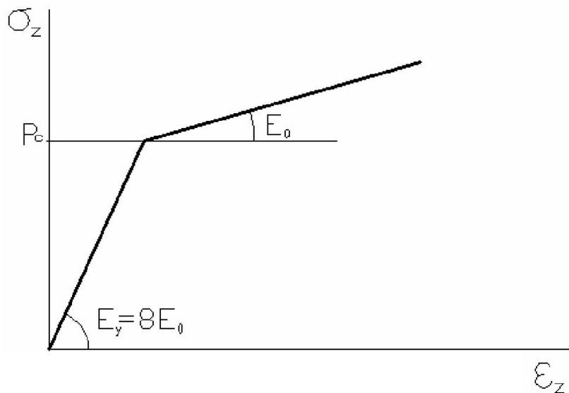
Непосредственное использование компрессионной зависимости  $\varepsilon_z = f(\sigma_z)$  в программе КРОСС для определения осадки  $W$  позволяет более четко отразить нелинейное деформирование грунта, чем на зависимости, представленной на графике слева.
