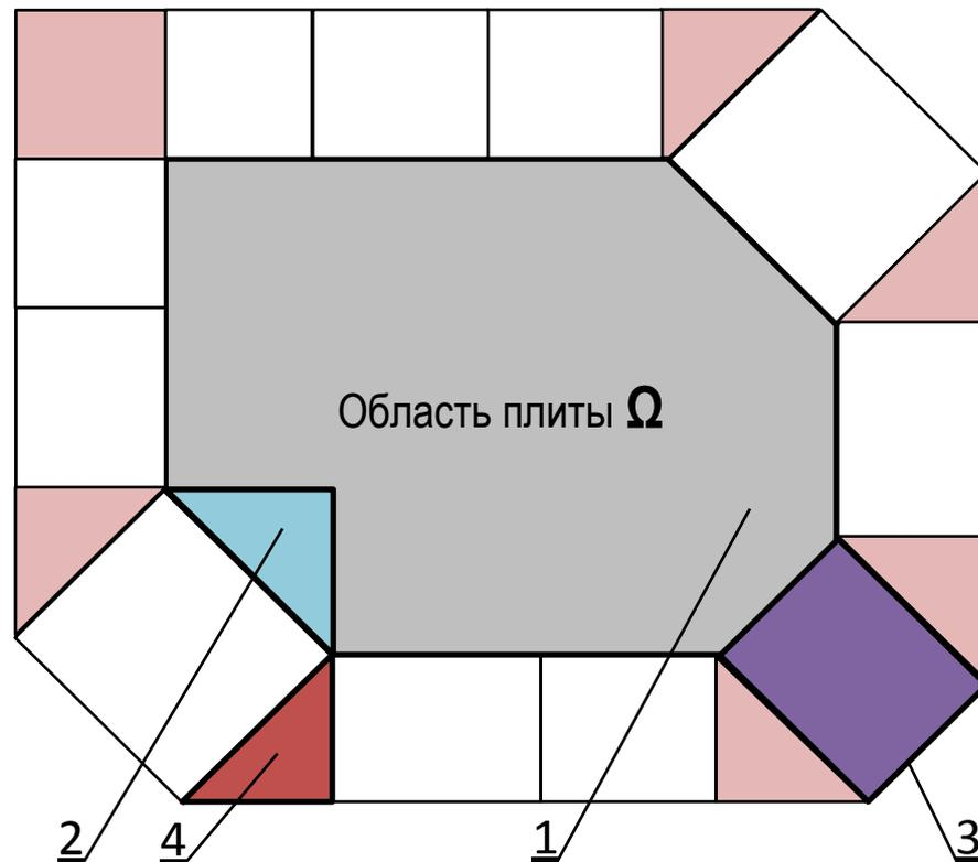
Расположение законтурных конечных элементов типа «клин» и «полоса»: 1 – плита; 2 – дополнение области  $\Omega$  до выпуклой; 3 – элемент-полоса; 4 – элемент-клин
