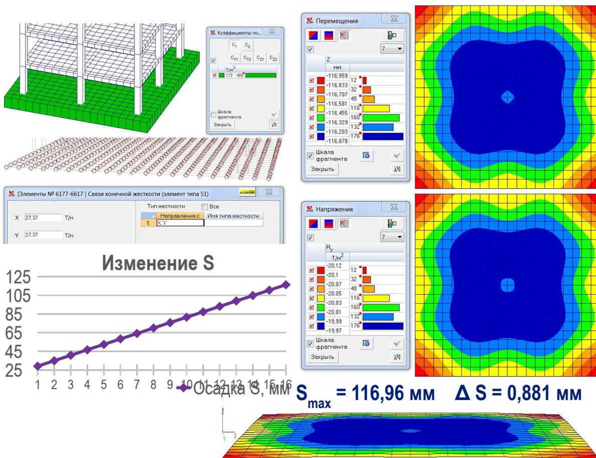
Главный недостаток — неучет распределительной способности основания, завышение деформаций на начальных стадиях за счет использования  $C_1$  от максимальной нагрузки на сооружение.
