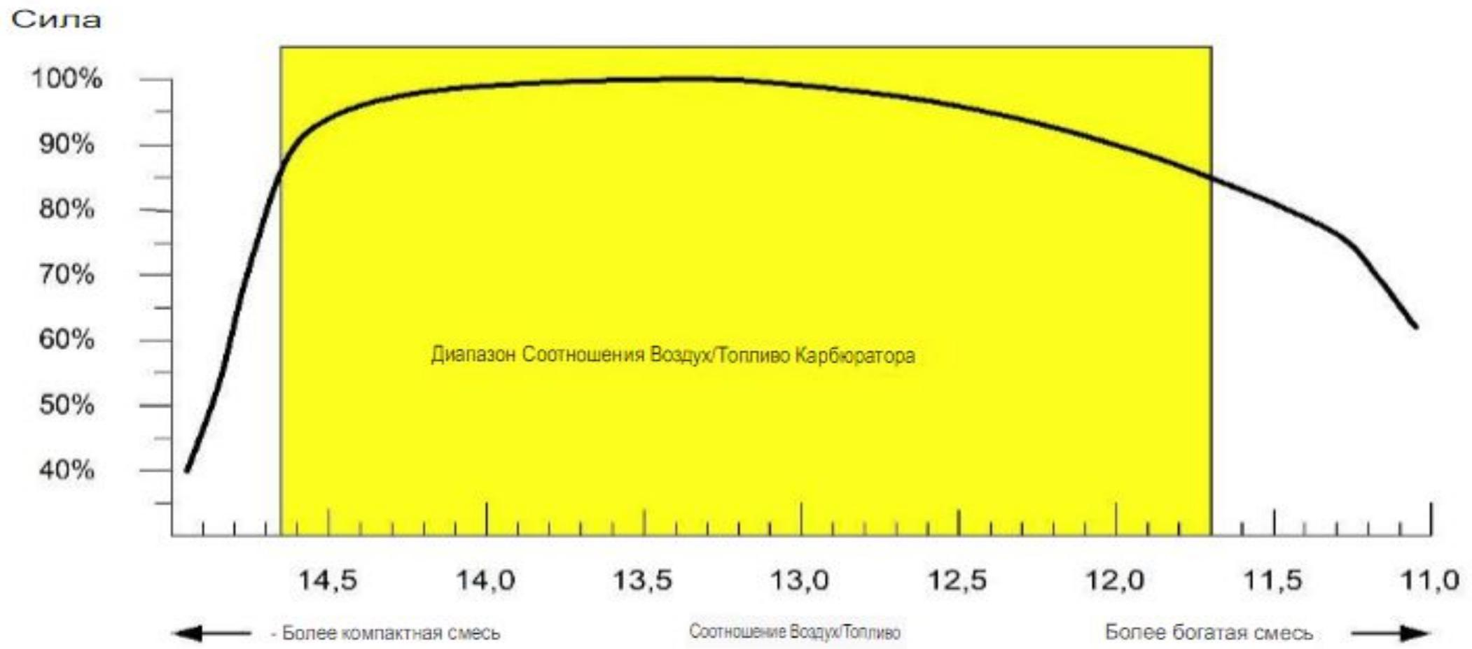
На графике видно, что диапазон карбюраторной системы слишком широк по отношению к системе с электронным впрыском топлива.
