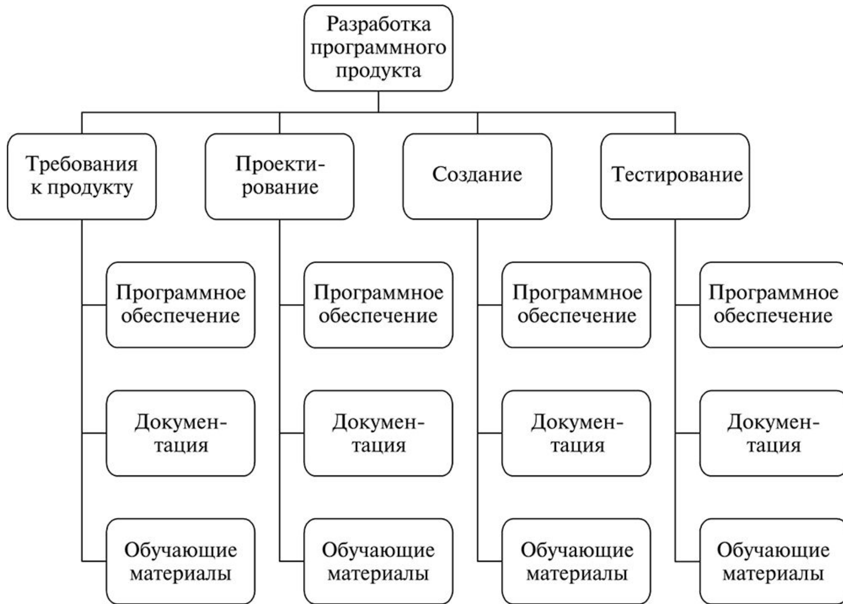
ИСР для проекта по разработке программного продукта (по жизненному циклу проекта)
