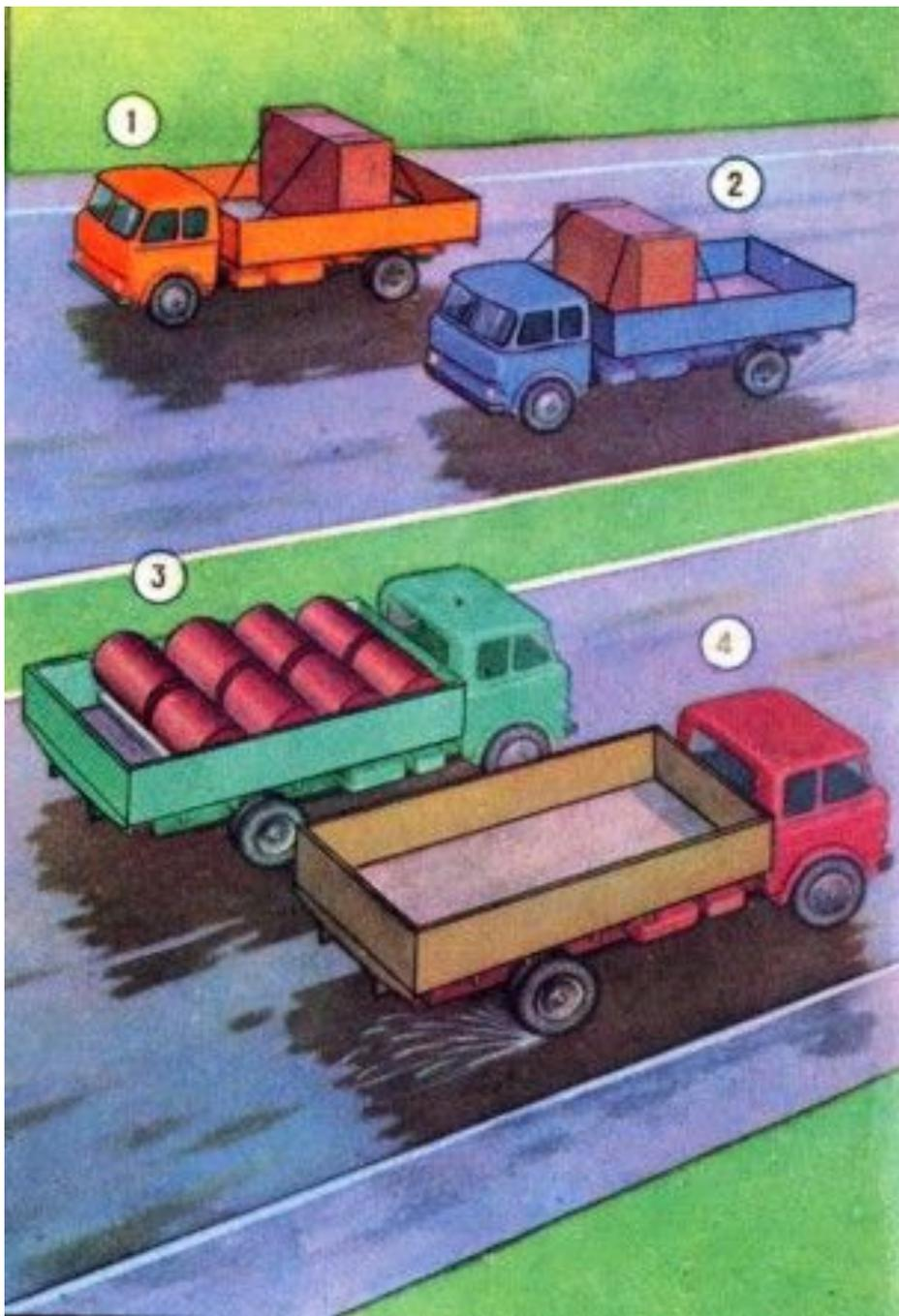
**Почему на одной и той же дороге автомашины 1 и 3 не буксуют, а автомашины 2 и 4 могут буксовать?**
