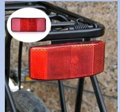
Сзади на велосипед устанавливают **световозвращатели** красного цвета, а впереди и сбоку – белого. Передний световозвращатель должен закрепляться на верхнем конце передней вилки, а задний – под седлом велосипеда или на мостике у заднего багажника. Боковые световозвращатели закрепляются на спицах колес.
