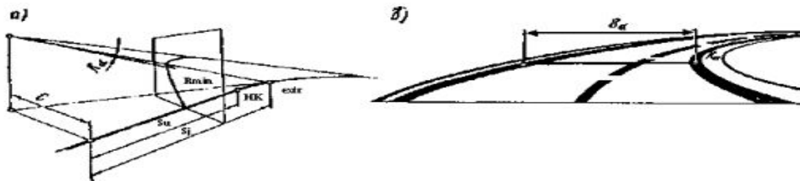
Рис. 1. Количественные характеристики зрительной плавности дороги: а - формирование изображения в картинной плоскости; б - видимое изображение
