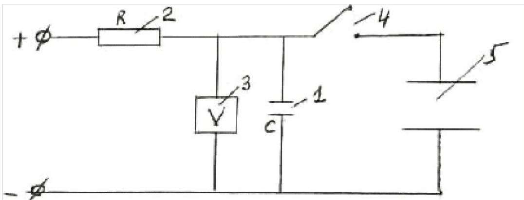
Рис. 3.13. Схема определения чувствительности ВВ к электрическому разряду (пояснения в teste)
