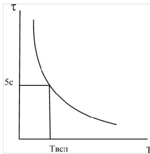
Рис. 3.10. Зависимость температура - время в методе ЛТИ
