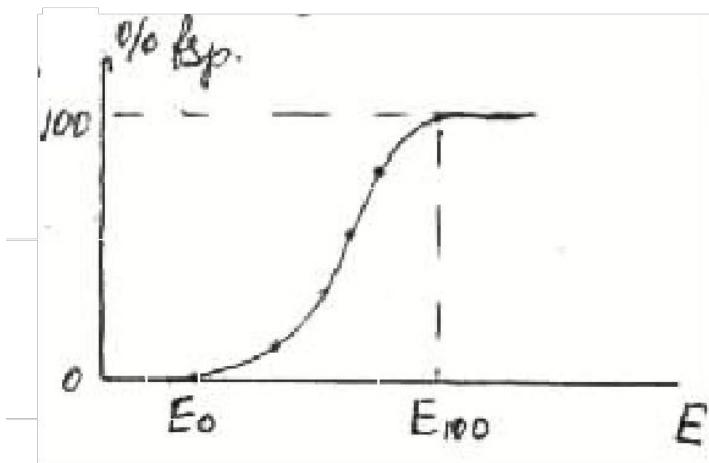
Рис. 3.14 Зависимость % взрывов от энергии искрового конденсатора
