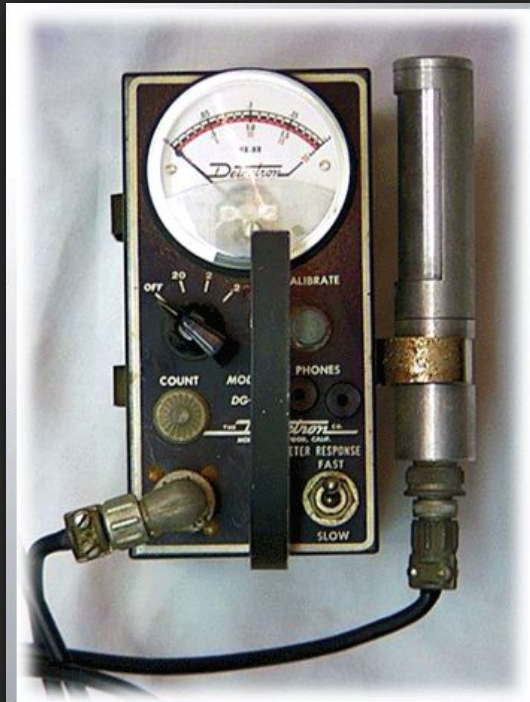
В изображенном на рисунке приборе радиационного контроля используется счетчик Гейгера.
