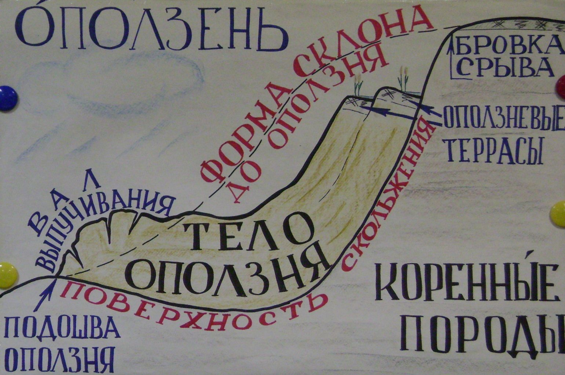
Рисунок 22 Элементы оползневого склона
