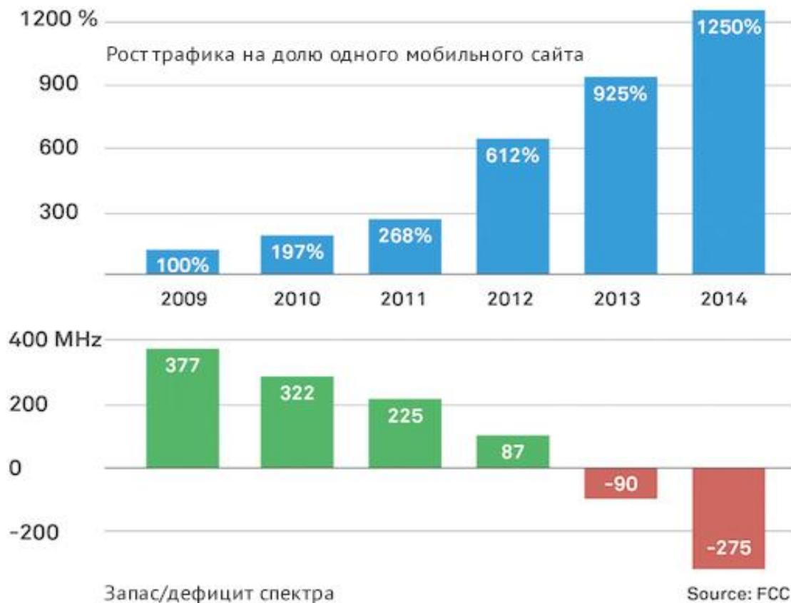
Такая перегрузка — самая большая уязвимость беспроводных сетей. Ее степень можно снизить, расширяя полосу рабочих частот, однако свободных мегагерц не так уж и много. Особенно это касается крайне важной нижней части спектра, где работают коммерческие беспроводные сети. Как показано на диаграмме выше, составленной FCC (Federal Communications Commission — прим. переводчика), дела будут становиться все хуже, по мере того, как наша жажда передачи мобильной информации будет расти.
