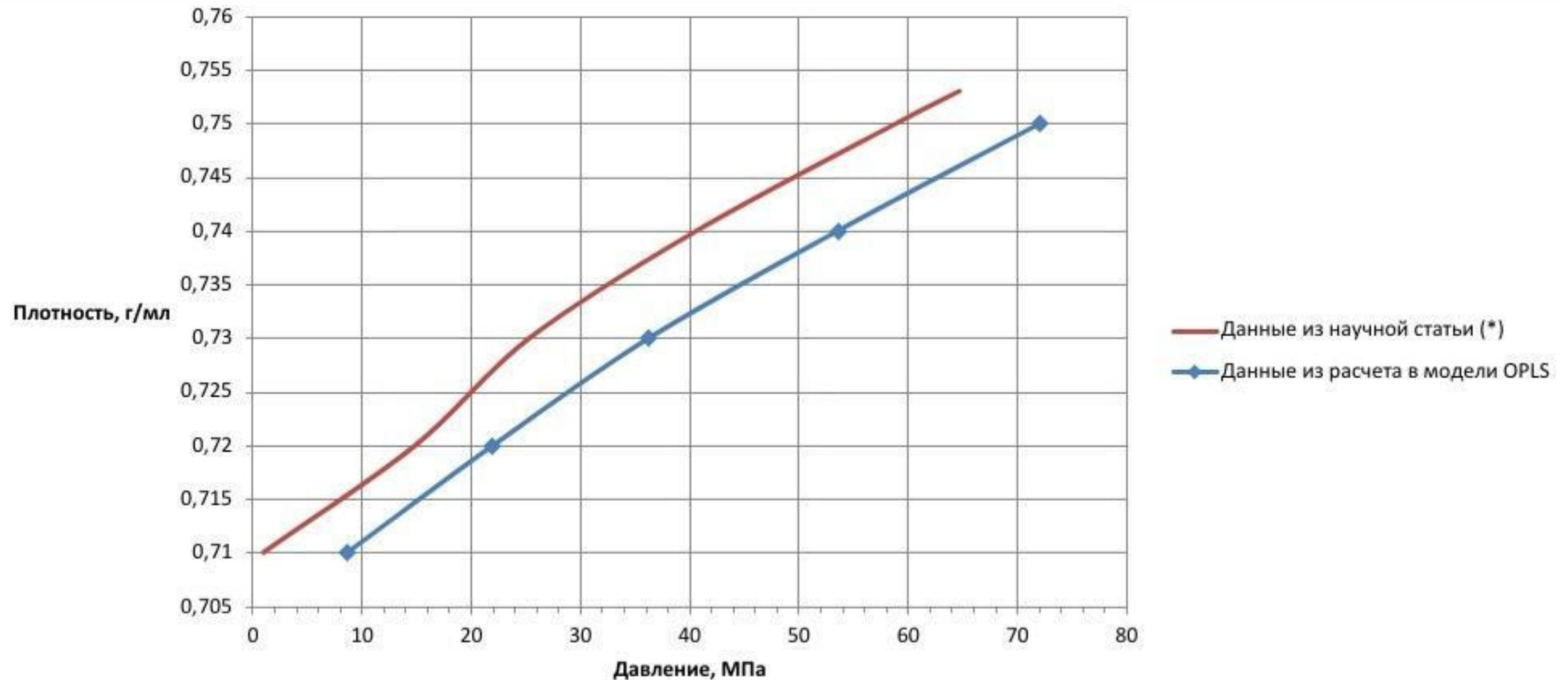
Сравнение результатов, полученных при расчете на суперкомпьютере, с результатами из научной статьи (\*). По вертикальной оси - давление в МПа, по горизонтальной оси - плотность в г/мл. Температура - 303.15К.
