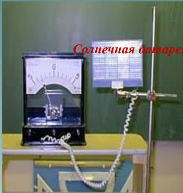
**Фотоэлемент.** При освещении некоторых веществ светом в них появляется ток, световая энергия превращается в электрическую. В данном приборе заряды разделяются под действием света. Из фотоэлементов составлены солнечные батареи. Применяются в солнечных батареях, световых датчиках, калькуляторах, видеокамерах.
