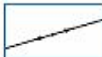
Линии электро- передач
