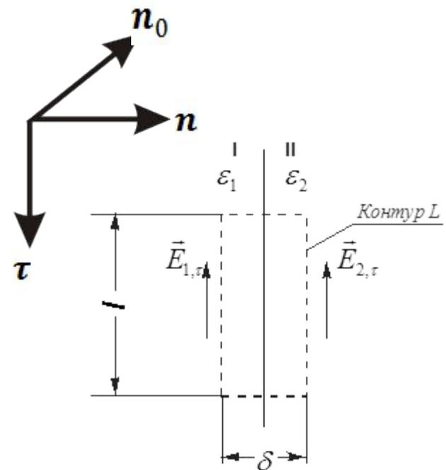
При переходе через поверхность разрыва тангенциальная компонента эл. поля непрерывна
