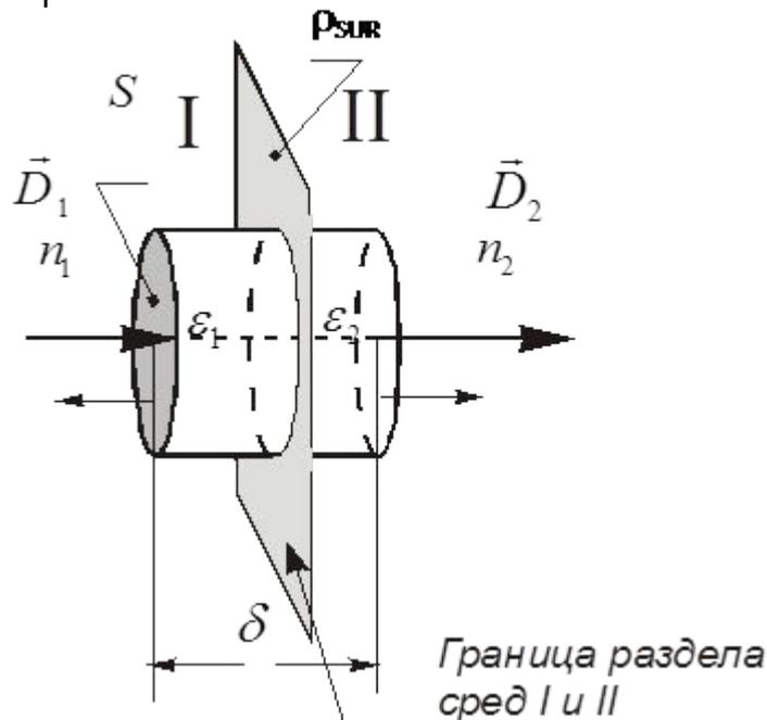
Наличие зарядов на поверхности приводит к скачку индукции, равно поверхностной плотности заряда в кулонах на кв. метр
