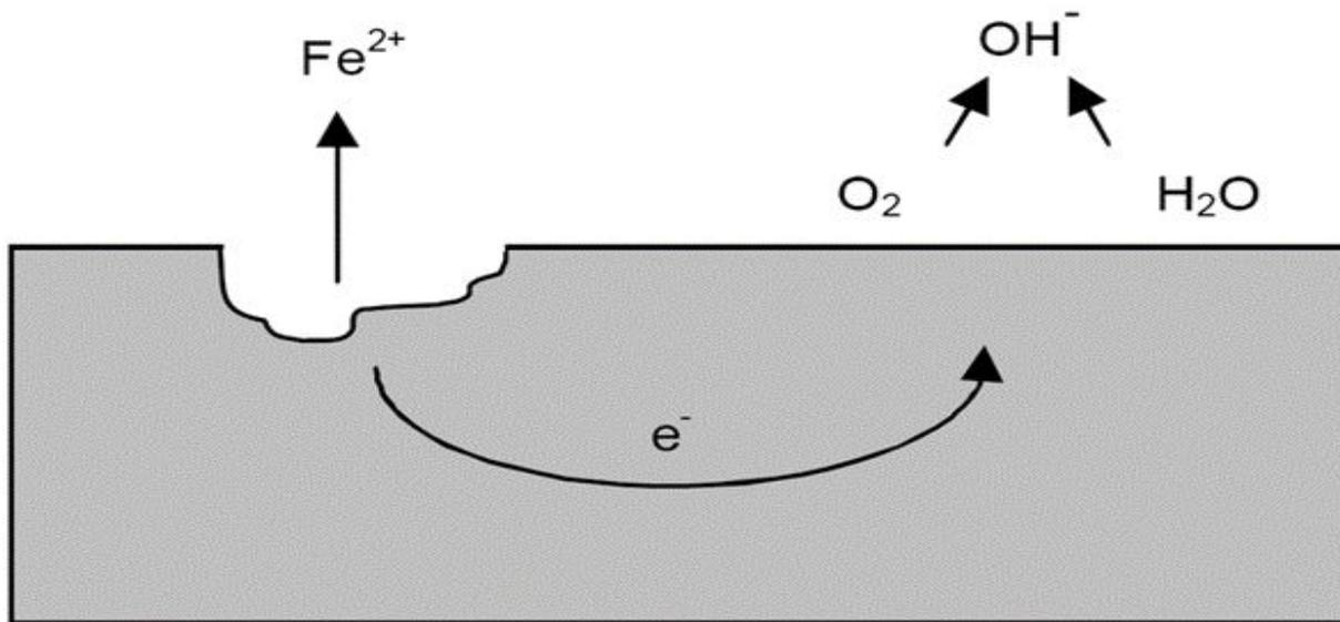
Кислородная коррозия железа в воде описывается суммарным уравнением:
