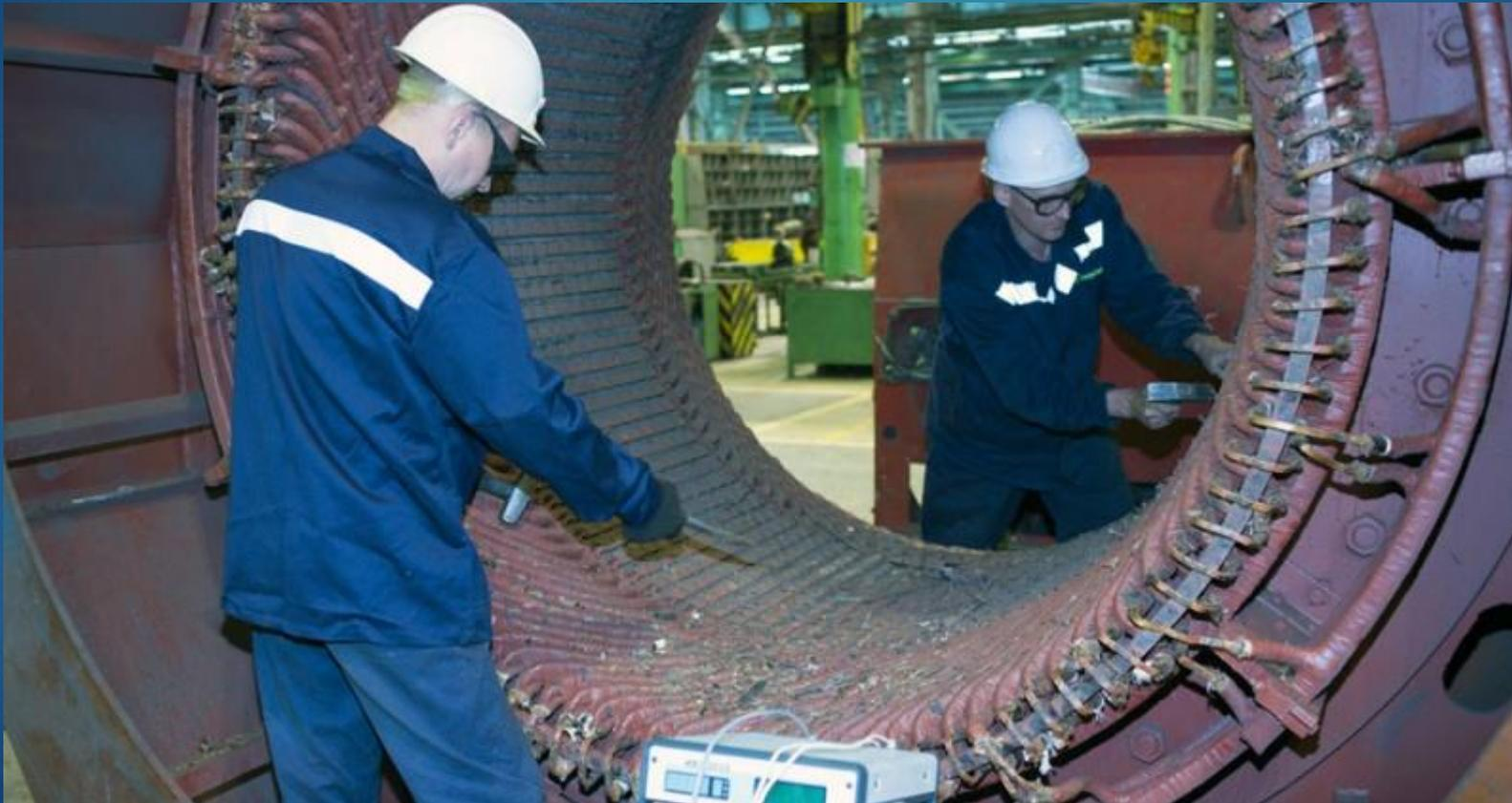
▶ Ремонт роторов синхронных двигателей
