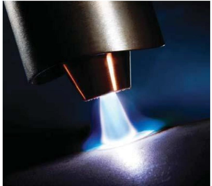
Носителями электричества в сварочной дуге являются электроны и ионы.
