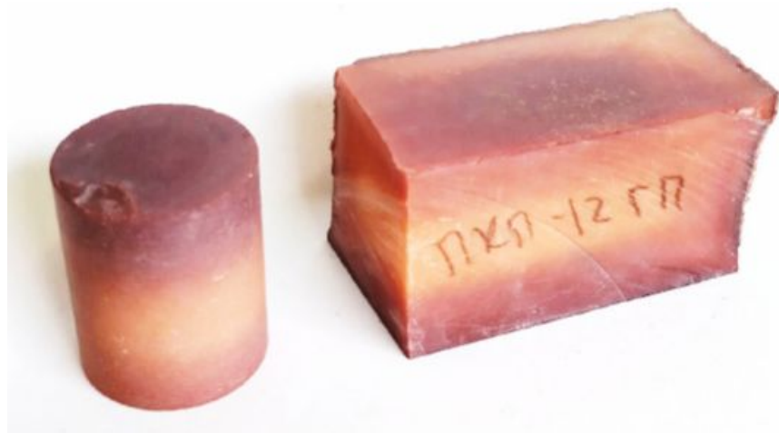
Фрагменты блока ПКП-12, полученного методом ГИП
