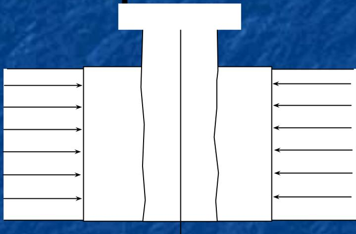
**Схема притока в скважину, несовершенную по качеству вскрытия**
