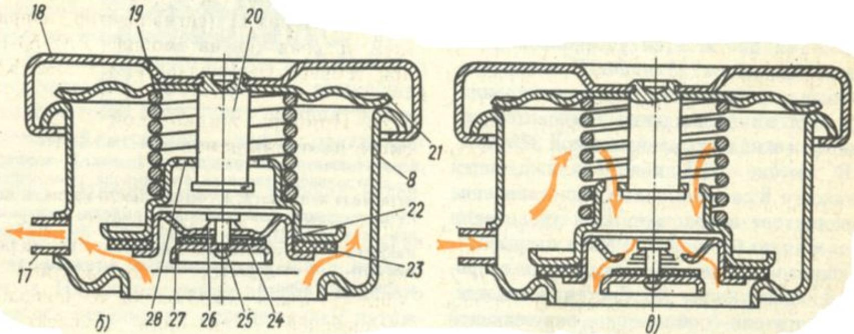
17—пароотводная трубка; 18—корпус пробки; 19—пружина парового клапана; 20—стойка; 21—запорная пружина; 22—паровой (выпускной) клапан; 23 и 24—прокладки парового и воздушного клапанов; 25—воздушный (впускной) клапан; 26—пружина воздушного клапана; 27—седло воздушного клапана; 28—отверстие для поступления воздуха
