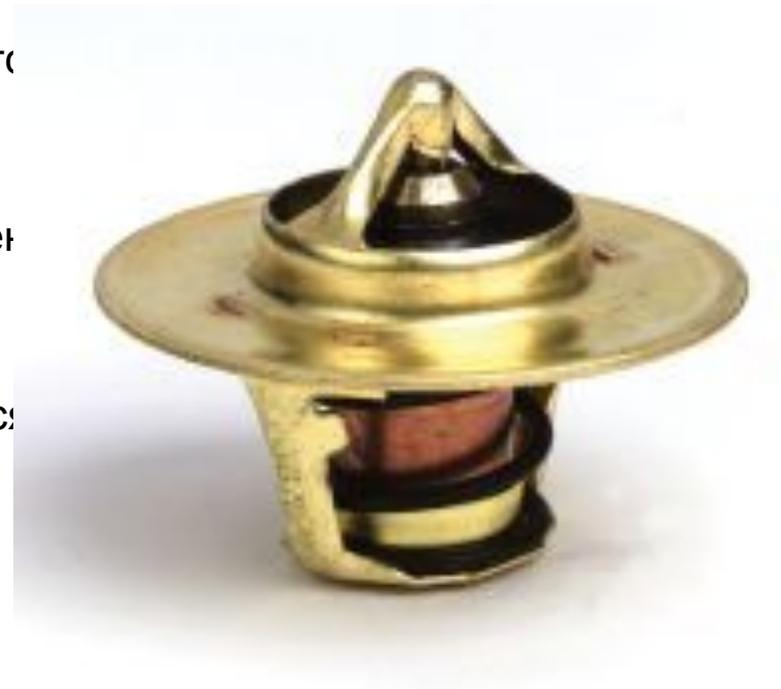
Конструктивно термостат представляет собой термочувствительный клапан, размещенный в латунной рамке. Клапан включает тарелку, насаженную на корпус. Корпус исполняет роль цилиндра, в который вставлен шток. Шток одним концом упирается в верхнюю рамку термостата, другим – в резиновую полость в корпусе. Между корпусом и резиновой полостью размещен термочувствительный элемент, состоящий из смеси гранулированного воска и меди.
