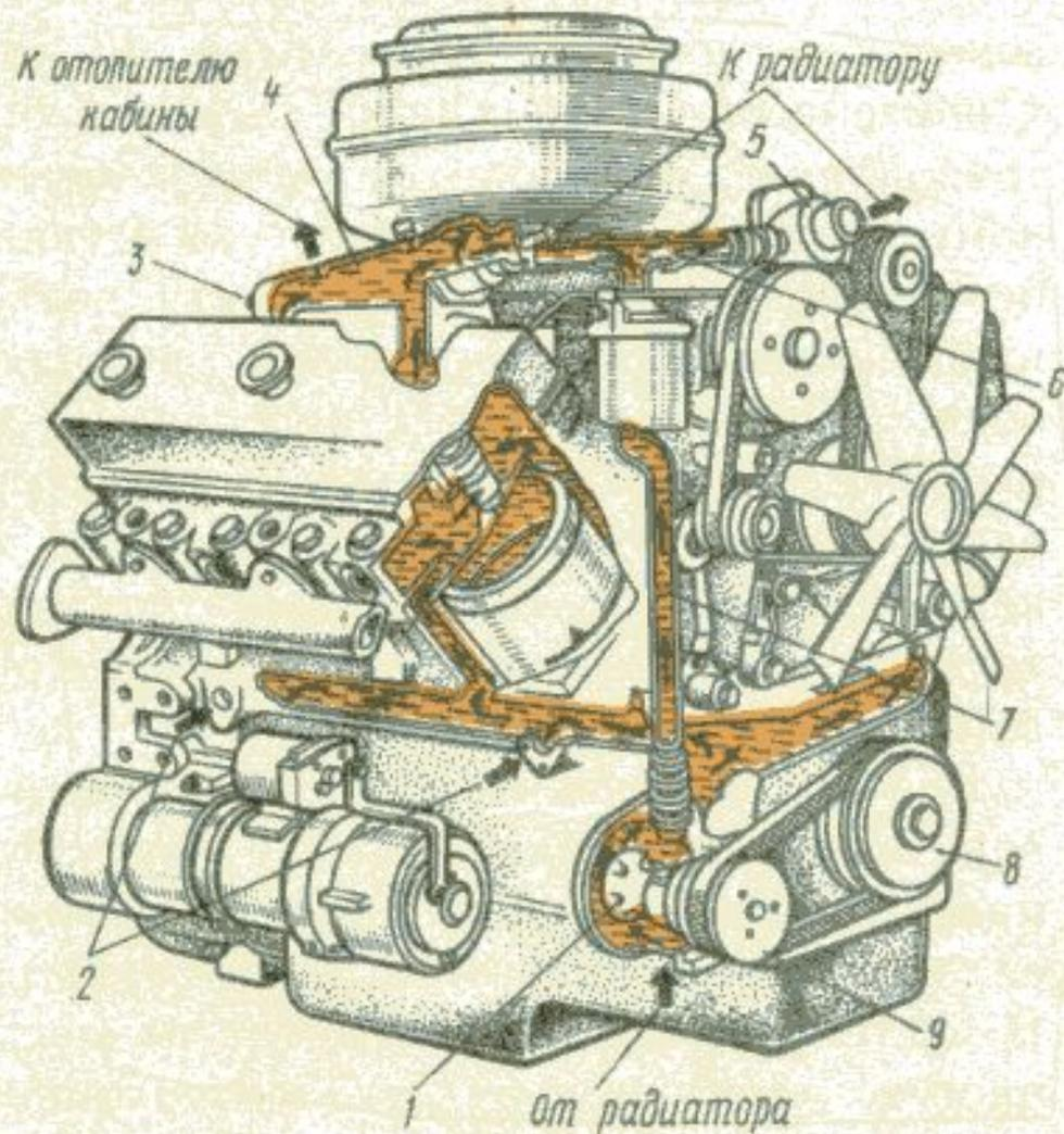
Рис. 39. Система охлаждения двигателя ЯМЗ-236М:
