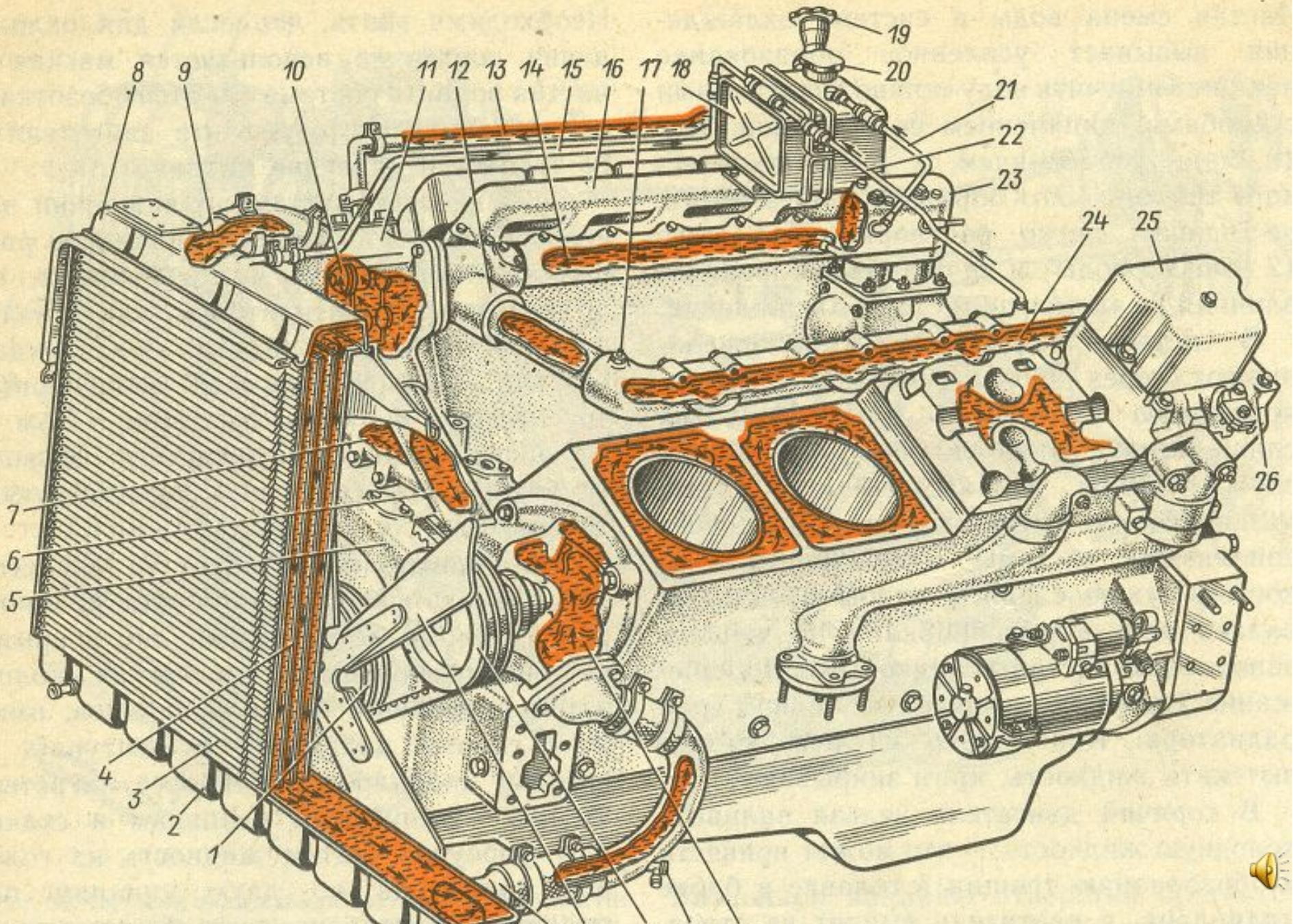
**Рис. 40. Система охлаждения двигателя КамАЗ-740.10:**
