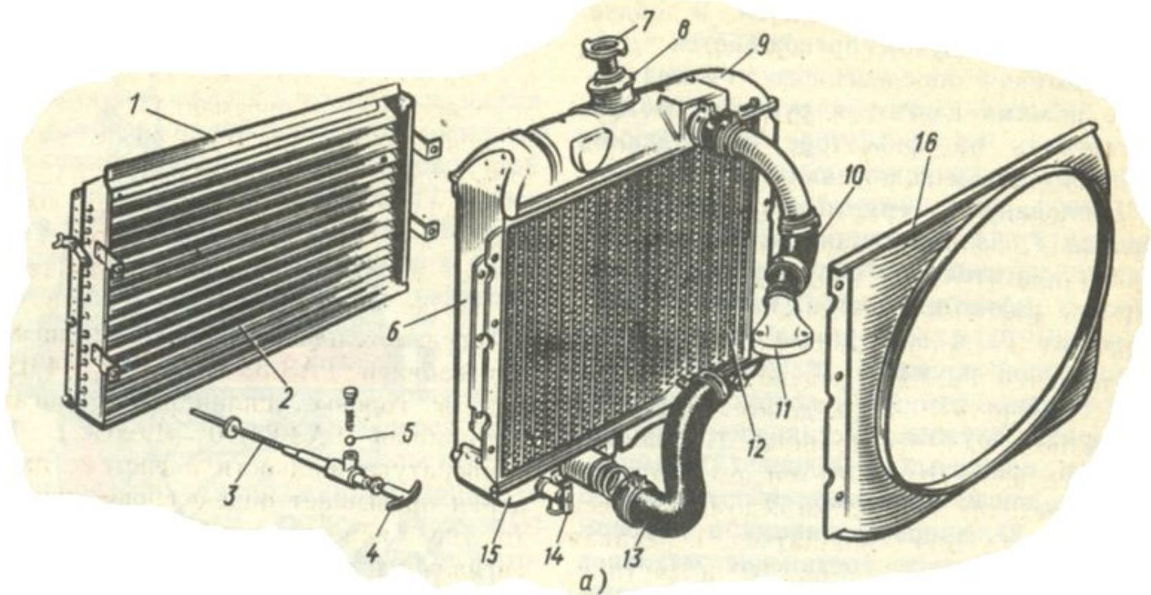
**Рис. 42. Элементы системы охлаждения:**
