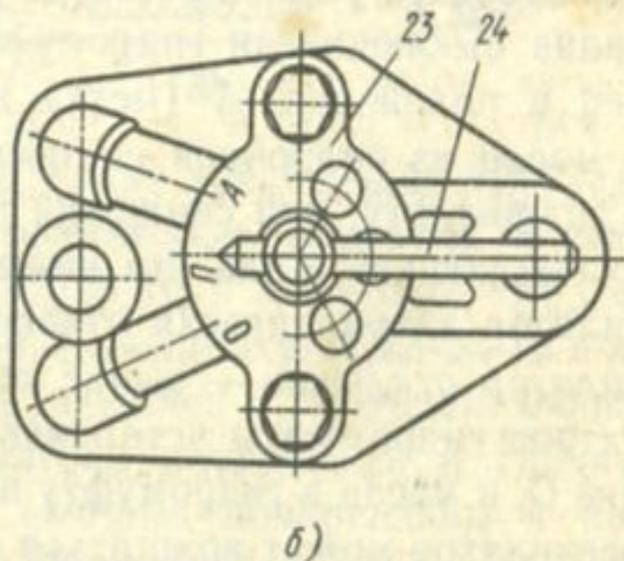
**Рис. 41. Гидромуфта привода вентилятора дизеля КамАЗ-740.10:**
