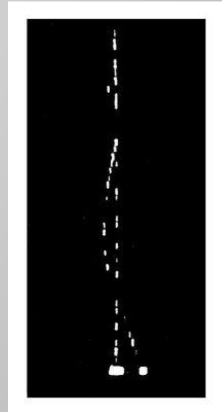
Трек частицы в узкоззорной искровой камере
