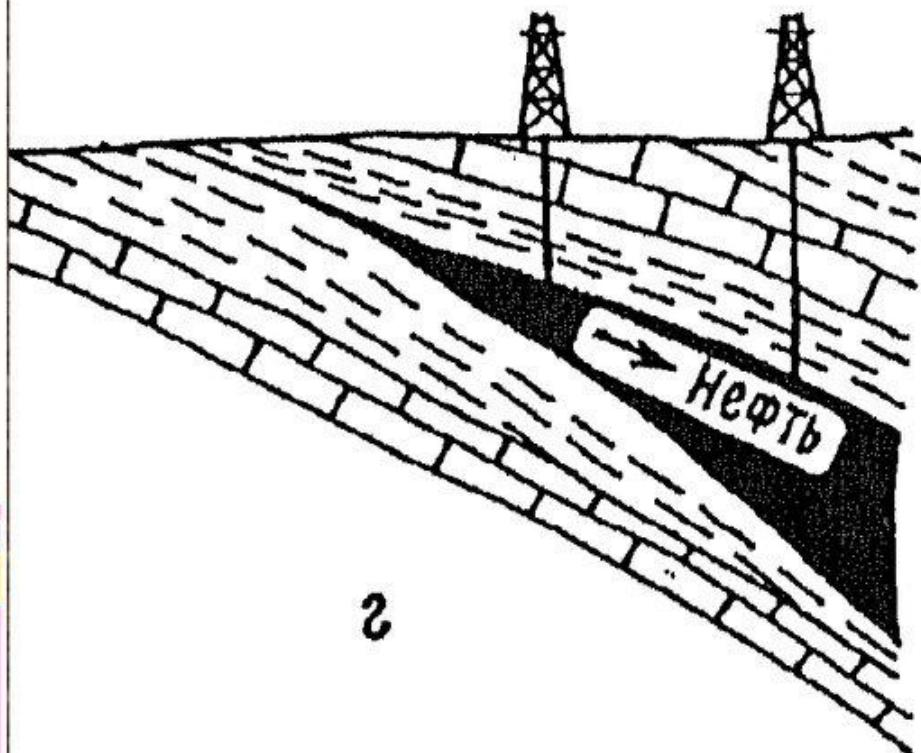
■ Гравитационный режим (рис. 1 г) имеет место в тех случаях, когда давление в нефтяном пласте снизилось до атмосферного, а имеющаяся в нем нефть не содержит растворенного газа. При этом режиме нефть стекает в скважину под действием силы тяжести, а оттуда она откачивается механизированным способом.
