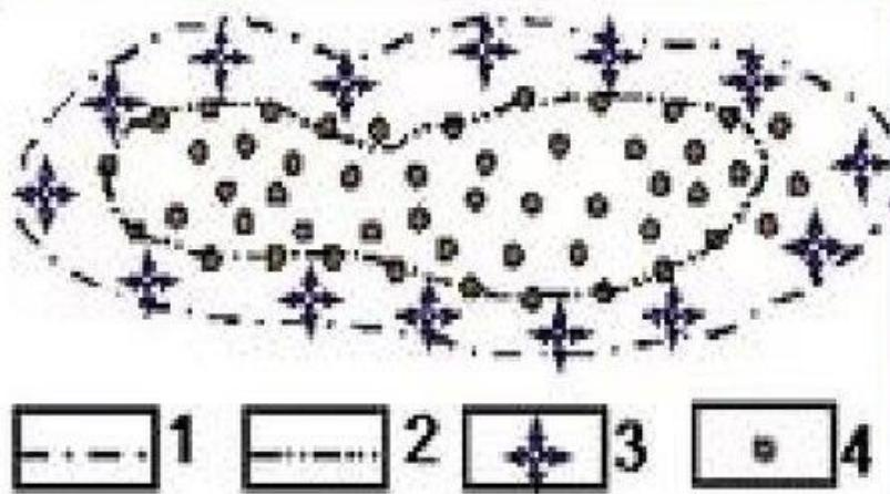
Рис. 17 Система разработки нефтяной залежи с приконтурным заводнением
