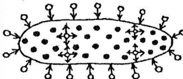
**Метод внутриконтурного заводнения** применяется для интенсификации разработки нефтяной залежи, занимающей значительную площадь. Сущность этого метода заключается в искусственном «разрезании» месторождения на отдельные участки, для каждого из которых осуществляется нечто подобное законтурному заводнению. При этом искусственно создается жестководонапорный режим работы залежи.
