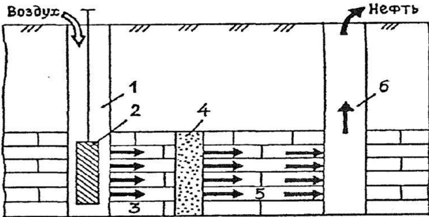
Рис. 6. Схема внутрипластового очага **горения**: 1 - нагнетательная (зажигательная) скважина; 2 - глубинный нагнетатель; 3 - выгоревшая часть пласта; 4 - очаг горения; 5 - обрабатываемая часть пласта (движение нефти, газов, паров воды); 6 - эксплуатационная скважина
