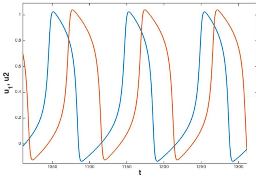
Сдвиг фаз колебаний в осцилляторах, обусловлен расстройкой управляющего параметра  $I_1 = 0.84$ ,  $I_2 = 1.0$
