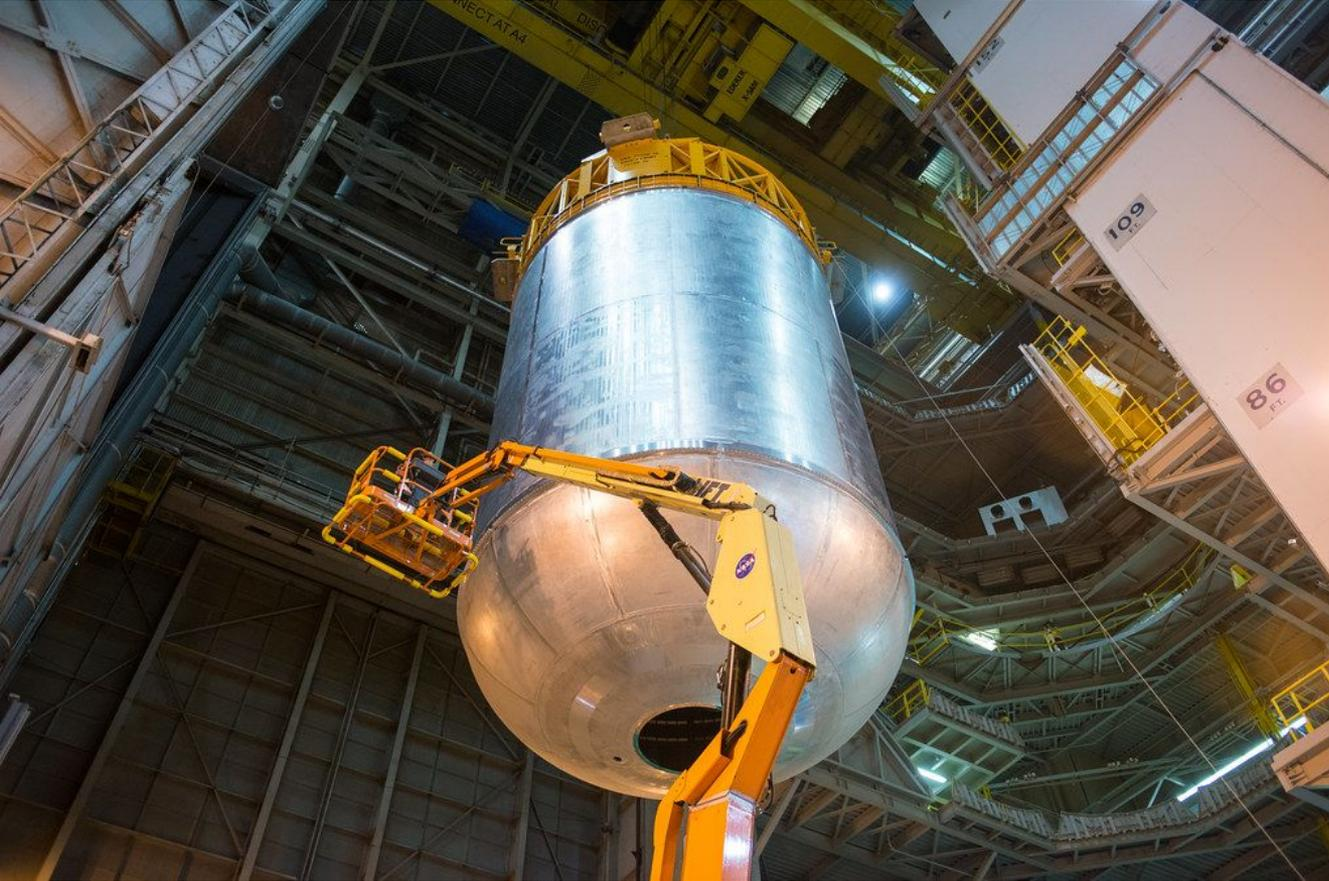
Бак жидкого окислителя- один из важных модулей космической ракеты, предназначенный для обеспечения двигателей ракеты окислителем для работы.
