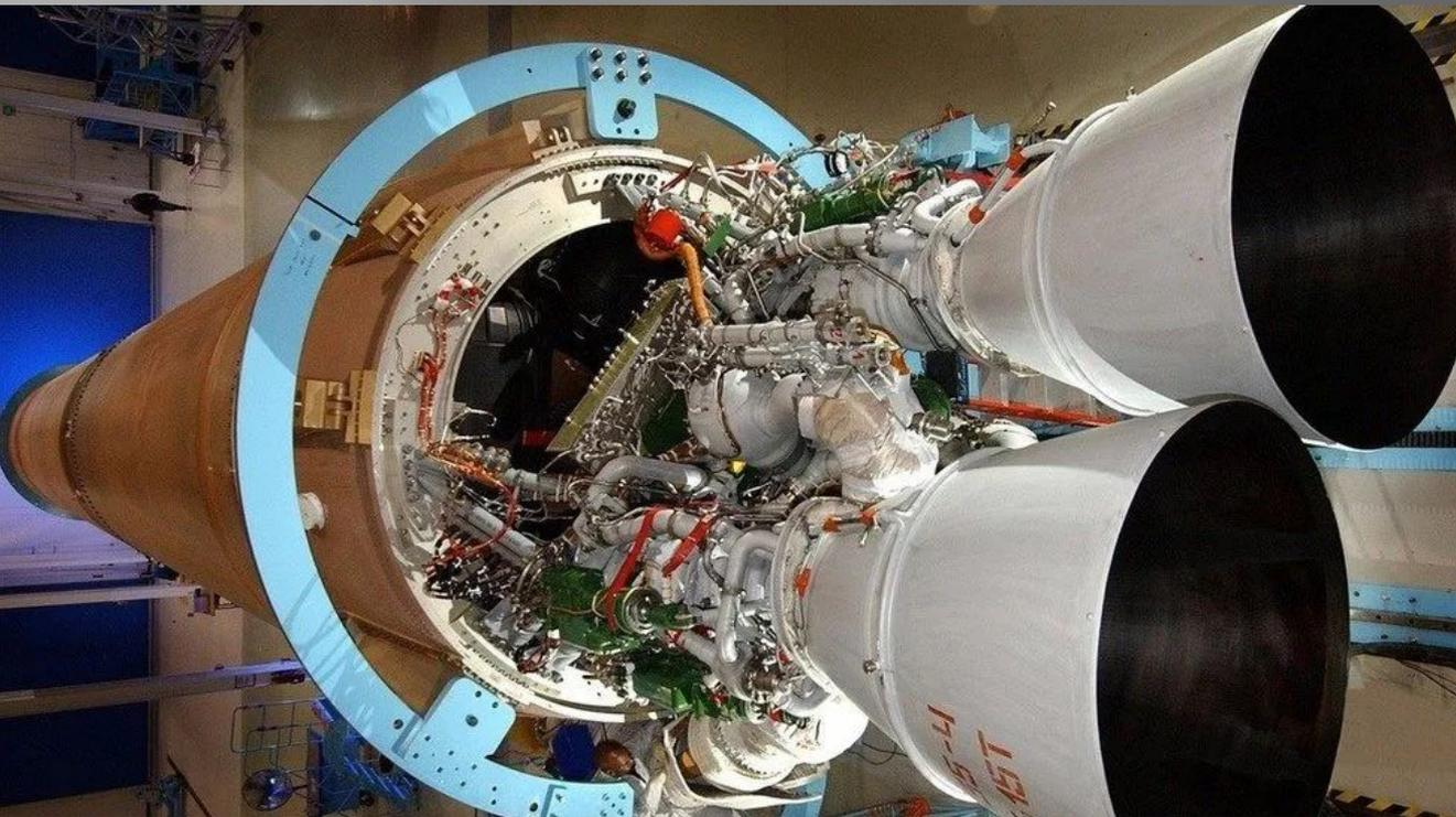
Насосы подают топливо в двигатели. Одни из насосов для окислительного топлива, другие для горючего.
