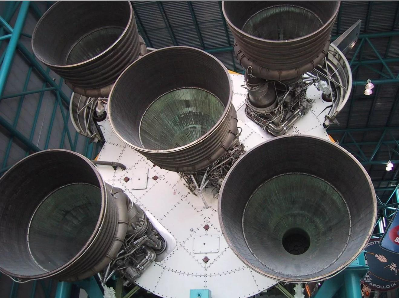
Каждое сопло направляет реактивную газовую струю назад и в результате позволяет ракете извлечь максимально возможный направленный вперед импульс и набрать максимально возможную скорость.
