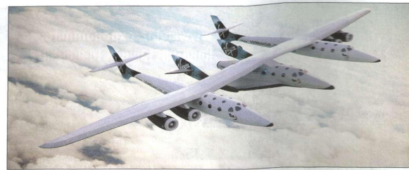
SpaceShipTwo пока самостоятельно не летает, но под крылом самолета-носителя WhiteKnightTwo налетает уже несколько сотен часов.
