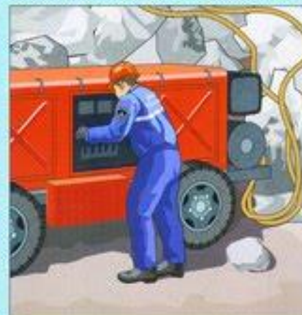
Подача воздуха в заваленные защитные сооружения с повреждёнными фильтровентиляционными системами
