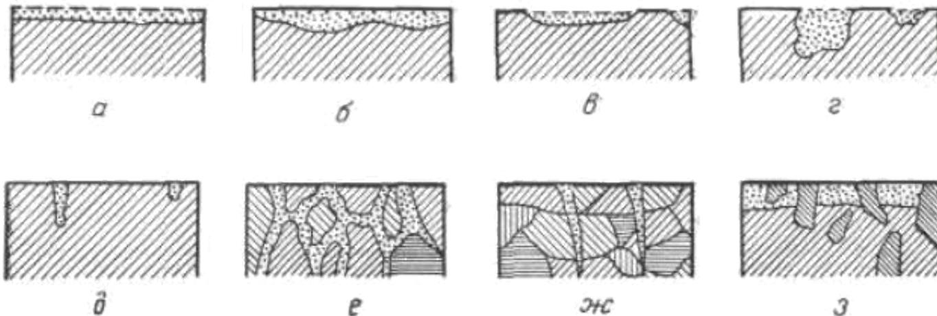
Характер и формы распространения коррозионного износа:
