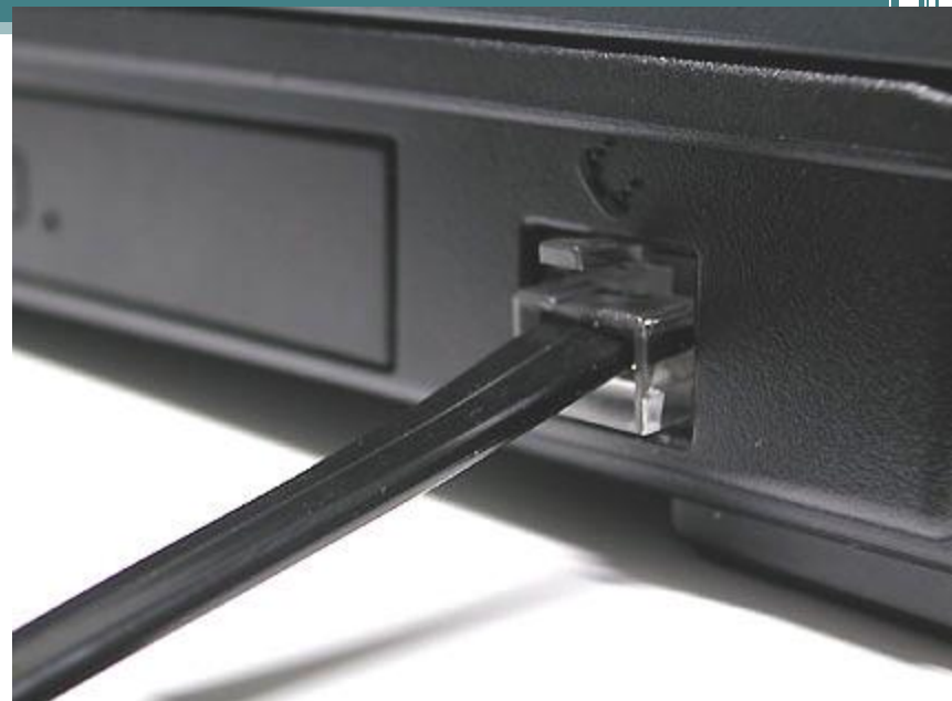
Модемный интерфейс RJ11
