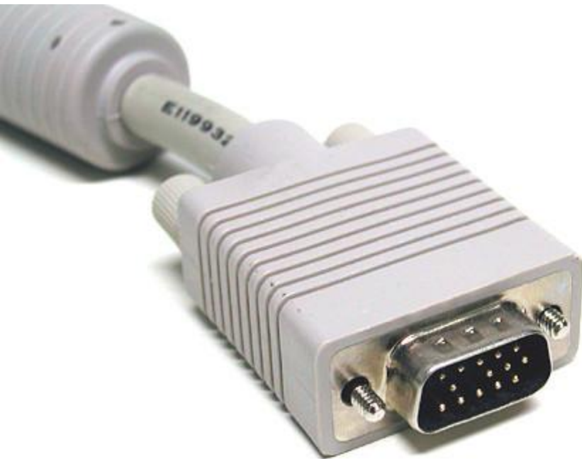
Интерфейс VGA на кабеле монитора
