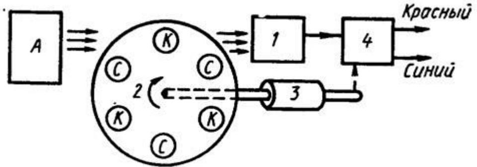
Рис. 12.9. Фотоэлектрический цветовой пирометр
