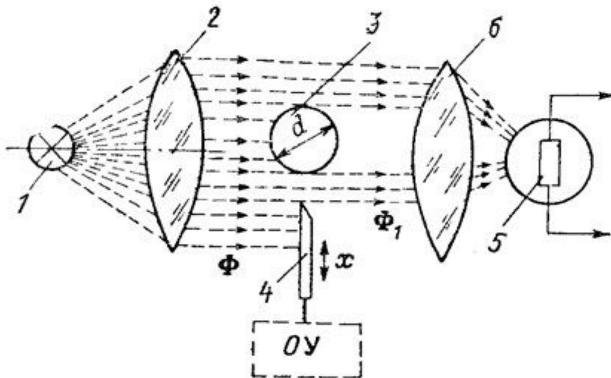
Рис. 2-7. Фотодатчик со световым потоком, прерываемым  $OY$
