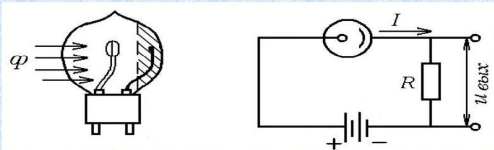
Конструкция представляет собой вакуумную или газонаполненную лампу, внутри которой имеются два электрода. Один электрод, называемый фотокатодом, представляет собой светочувствительный слой, наносимый на внутреннюю поверхность стеклянной колбы лампы. Специальным выводом, впаянным в стенку колбы, этот слой присоединяется к минусу источника напряжения. Явление испускания электронов светочувствительным слоем при его освещении и называется внешним фотоэффектом.
