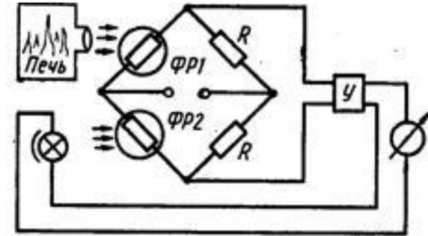
Рис. 12.8. Фотоэлектрический яркостный пирометр — датчик высоких температур
