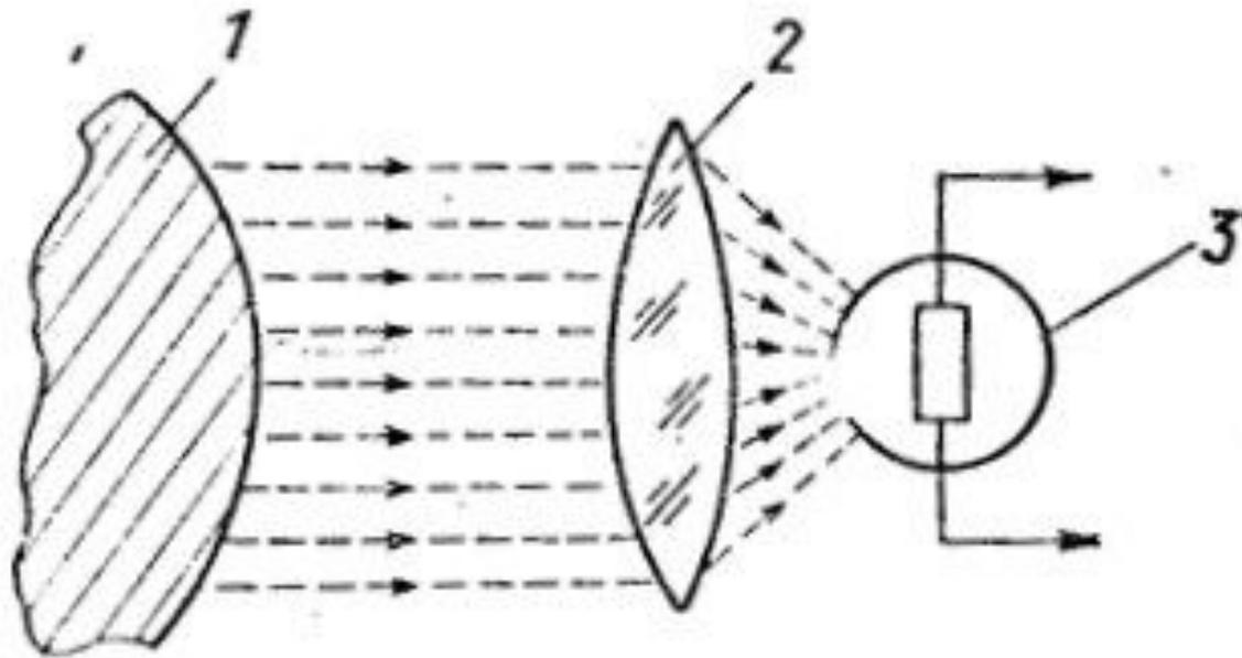
Рис. 2-9. Фотодатчик со световым потоком, излучаемым ОУ.
