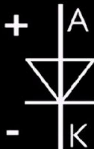
Условное обозначение на принципиальных электрических схемах
