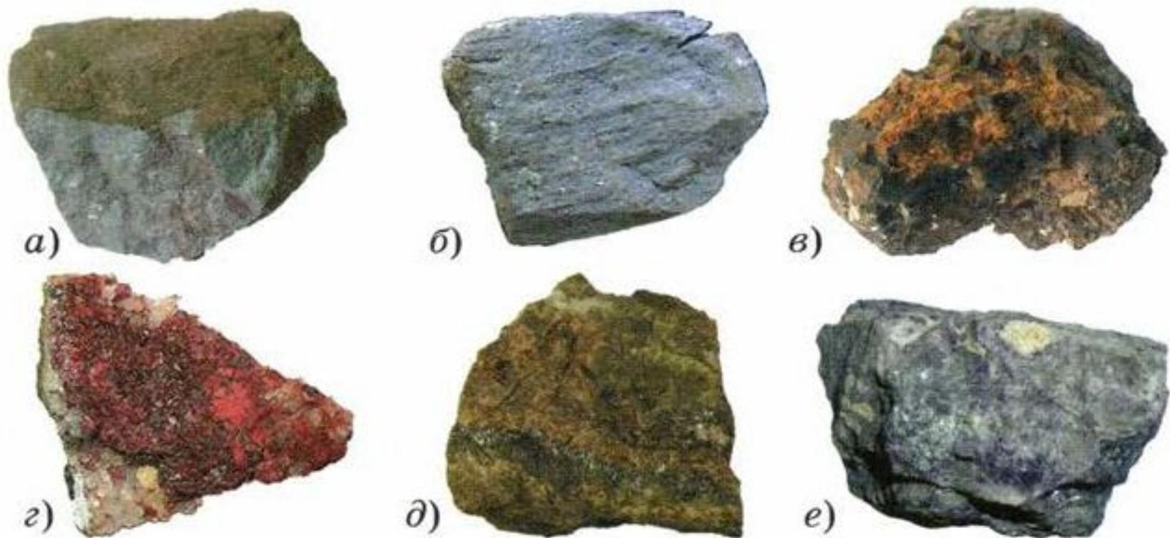
**Рис. 38.** Минералы: *a* — красный железняк; *б* — магнитный железняк; *в* — бурый железняк; *г* — киноварь; *д* — цинковая обманка; *е* — свинцовый блеск
