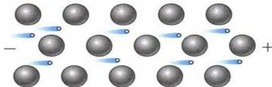
**Рис. 28.** В металлических кристаллических решётках подвижные электроны под действием электрического поля перемещаются, создавая электрический ток
