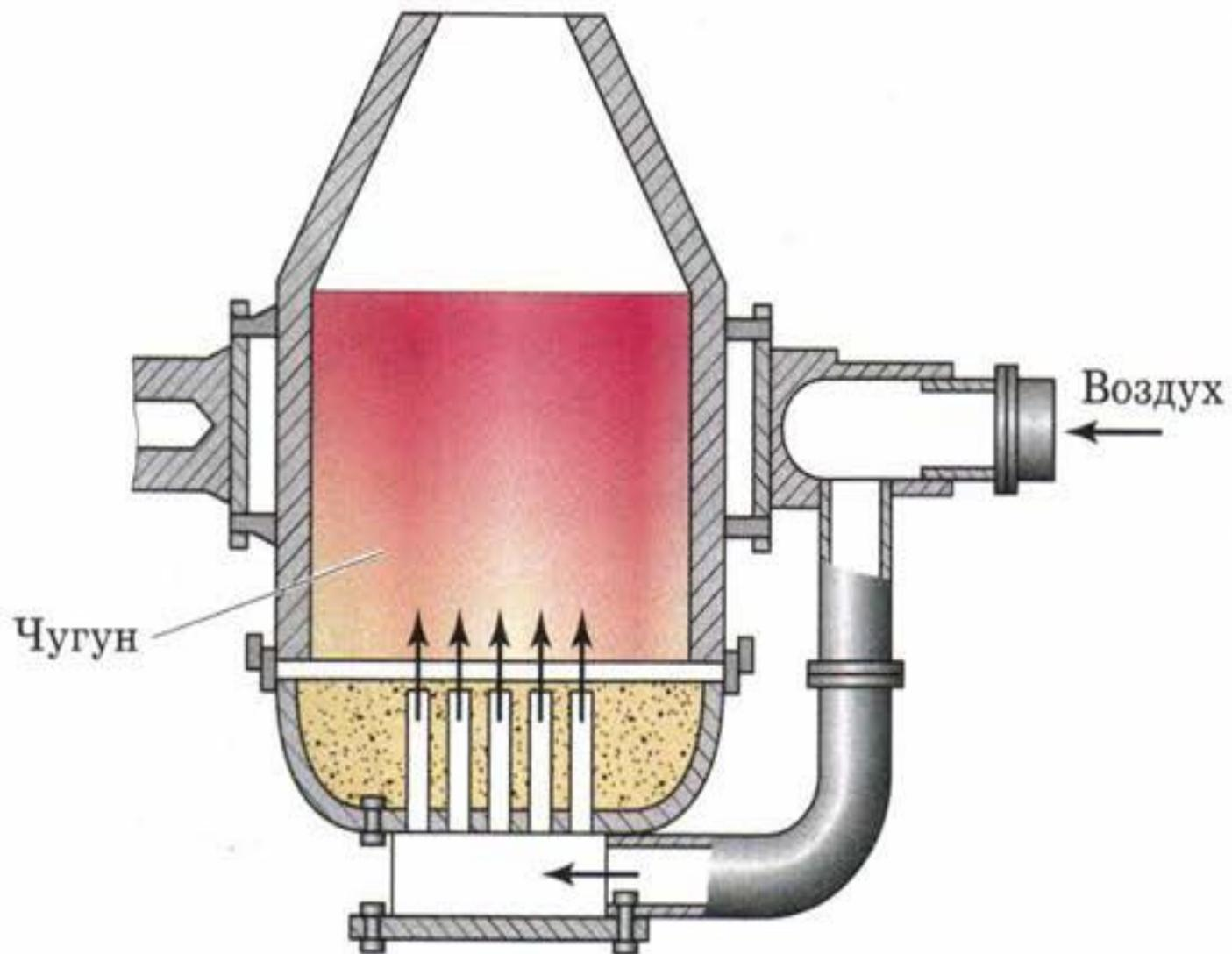
Рис. 41. Конвертер
