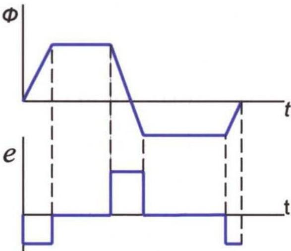
Зависимость ЭДС от изменения магнитного потока
