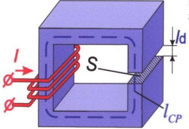
Для неоднородной магнитной цепи с воздушным зазором
