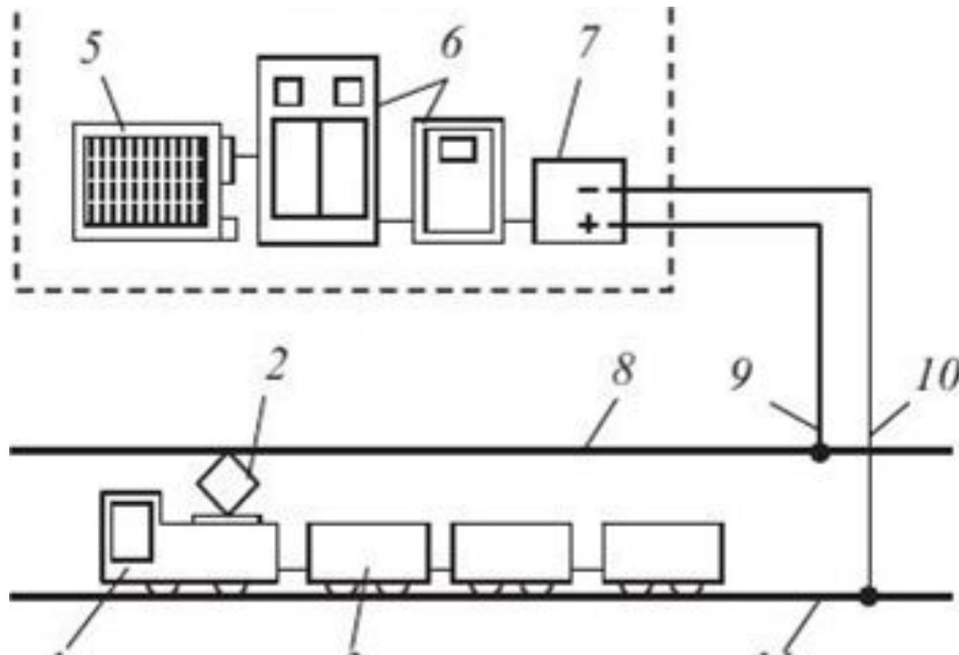
**Принципиальные схемы тяговой подстанции и откатки контактными электровозами постоянного тока:**
